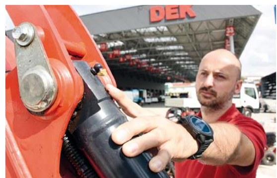
Prodejce ukázal mazací místa, která se při delší zápůjčce musejí doplňovat tukem
