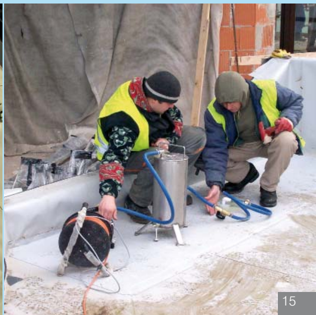
09| Pracovníci firmy DEKPROJEKT provádí podtlakovou kontrolu těsnosti systému DUALDEK (snímek z kontroly ploché části střechy nad byty)
