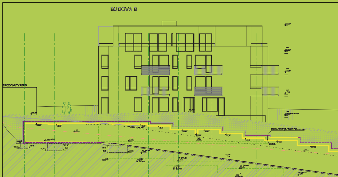
17| Objekty jsou situovány do mírně svažitého terénu, střechy garáží proto provedeny v několika výškových úrovních. Násyp zeminy o mocnostech od 0,5 do 1,5 m provedený na střeše vyrovnává kaskádu střech opět do mírného svahu.
