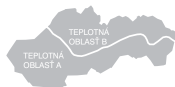
Obr. 01 | Rozdelenie Slovenska na teplotné oblasti pre letné obdobie Legenda: Teplotná oblasť: \theta_{ai,m} [°C], oblasť A: 20,5 | oblasť B: 18,2
