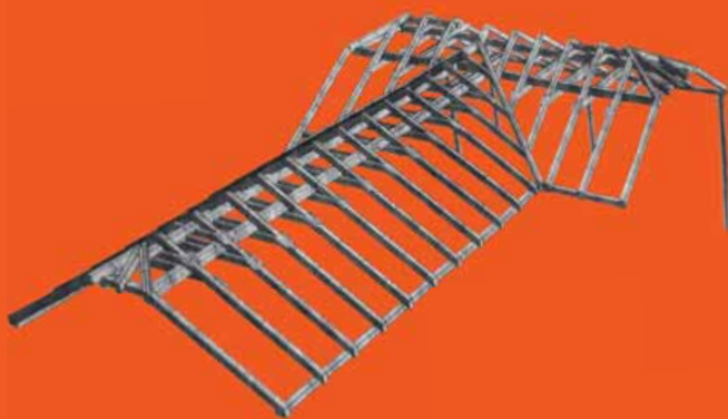
3D prostorový model konstrukce krovu
