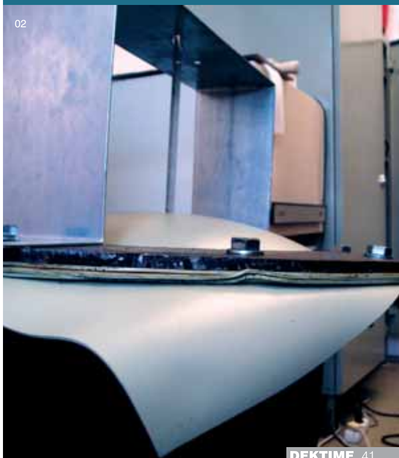
01, 02 | Zkouška biaxiálního protažení fólie ALKORPLAN při současném měření tlaku
