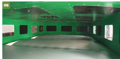
Zkouška fóliové hydroizolace ve vakuové komoře
