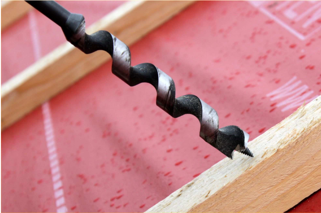
Obr. 16 - Špirálový vrták pre zahĺbenie dosadajúcej plochy pre hlavu skrutky
