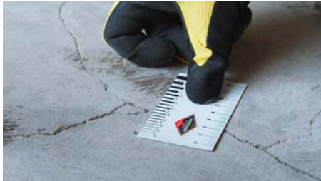
3. Přeměří se šířka spar, všechny nad 2 mm je potřeba vyspravit.
