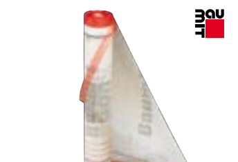
Sieťovina výstužná Baumit StarTex sklotextilná sieťovina na armovanie (vystuženie) stierkovej vrstvy, oká 4x4mm, plošná hmotnosť 145g/m 2 , 55m 2 /bal.
