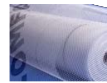
Sieťovina výstužná Omfa sklovláknitá mriežková tkanina, určená na výstuž vonkajších omietok, plošná hmotnosť 145g/m 2 , 50m 2 /bal.
