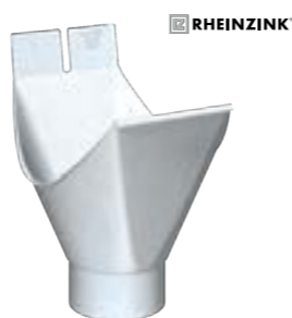
Kotlík RHEINZINK TiZn kotlík závesný polkruhový rozvinutej šírky 330 mm, zváraný, zvislý priemer 100 mm, titanizinkový plech, lesklý
