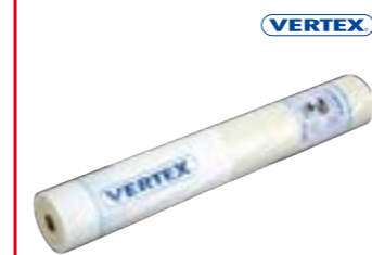
Sieťovina výstužná Vertex R117 tkanina na armovanie (vystuženie) stierkovej vrstvy, oká 4,3x4,3mm, plošná hmotnosť 145g/m 2 , 55m 2 /bal.
