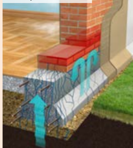
07 | Injektážny prípravok vytvorí v murive hydrofóbnu zábranu
