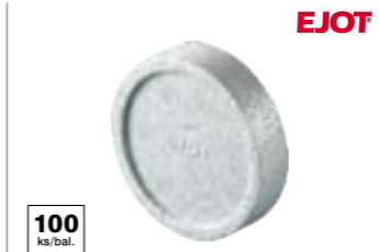
Zátka systémová Ejot STR Rondelle EPS na zápusťnú montáž, na použitie so skrutkovacími kotvami Ejotharm STR U 2G, materiál EPS 70F šedý, priemer 65mm, 100ks/bal.
