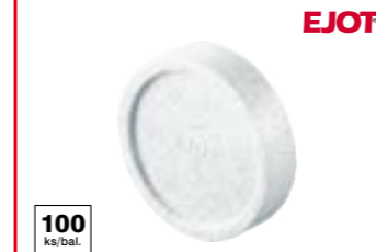
Zátka systémová Ejot STR Rondelle EPS na zápusťnú montáž, na použitie so skrutkovacími kotvami Ejotharm STR U 2G, materiál EPS 70F biely, priemer 65mm, 100ks/bal.
