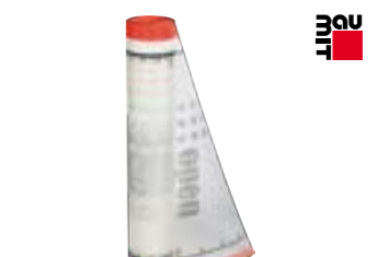
Sieťovina výstužná Baumit OpenTex sklotextilná sieťovina na armovanie (vystuženie) stierkovej vrstvy, oká 4x4mm, plošná hmotnosť 145g/m 2 , 55m 2 /bal.
