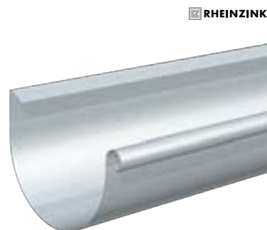
Žľab pododkvapový RHEINZINK TiZn žľab polkruhový, titanizinkový plech, lesklý, rozvinutá šírka 330 mm
