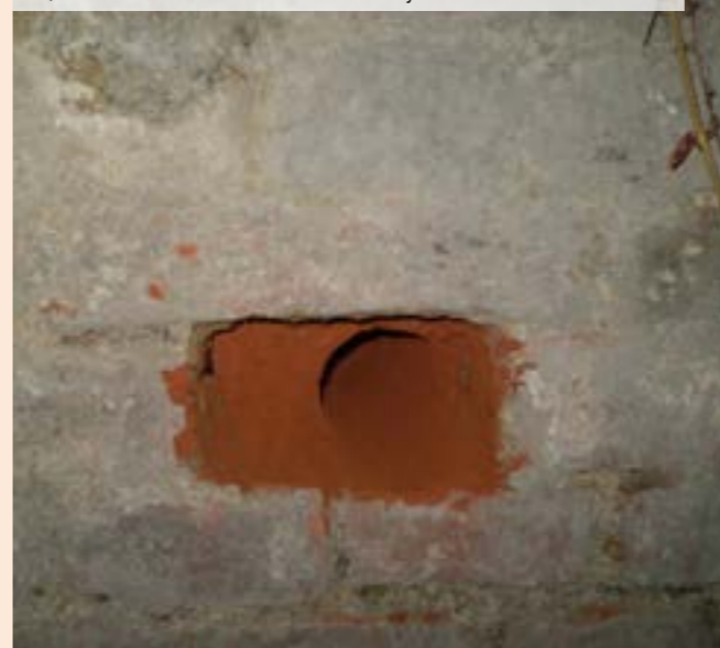
02 | Odobranie materiálu muriva za účelom vyhodnotenia vlhkového stavu
