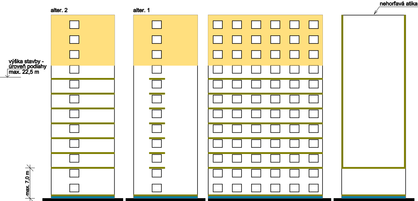
Samostatne stojaca budova s výškou stavby viac ako 22,5 m a s tepelnou izoláciou s hrúbkou viac ako 100 mm
