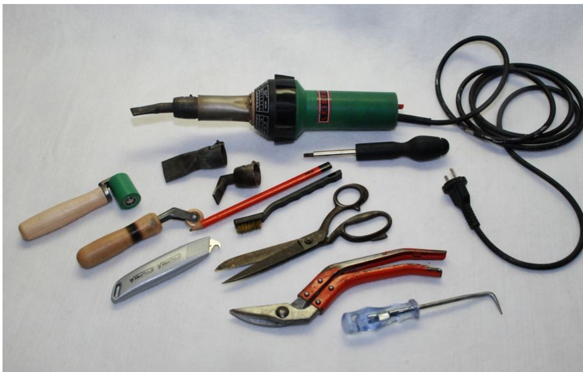
Obrázek 3.: Základní nástroje pro provádění hydroizolací z fólií DEKPLAN
