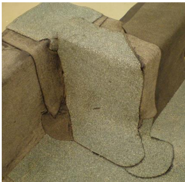
Obrázek /11/ Natavení koutové tvarovky 4b upravené zprava na tvar rohové tvarovky 2b a natavení koutové tvarovky 4a, obě s posypem
