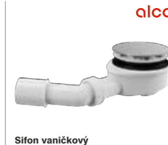
Sifon vaničkový Alca A491CR snížený pro sprchové vaničky s odtokovým otvorem, snížená stavební výška 65 mm, materiál polypropylen (tělo), pochromovaný plast (víko), odtokový otvor ø90 mm
