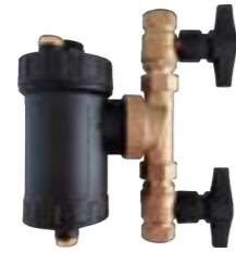
Filtr magnetický DEK MAG34 3/4" pro odstranění magnetických i nemagnetických nečistot a kalů v otopných systémech, filtr 700 μm, síla magnetu 10 000 Gauss, max. provozní tlak 10 bar, velikost připojení 3/4"
