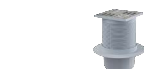
Vpust podlahová Alca APV2 spodní, mřížka z nerezové oceli, vodní zápachová uzávěra, rozměry 105x105/50mm
