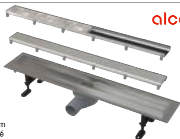
Žlab sprchový nerezový Alca APZ 13 Double design roštu je určen oboustranným roštem Double – z jedné strany plný nerez, z druhé strany možnost vložení dlažby nebo vodovzdorného dřeva do tloušťky 12 mm, materiál: nerezová ocel, vodorovný odtok, stavební výška 81 mm
