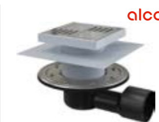
Vpust podlahová Alca APV3444 boční, mřížka, příruba a límec z nerezové oceli, vodní a suchá zápachová uzávěra, rozměry 150x150/50/75mm
