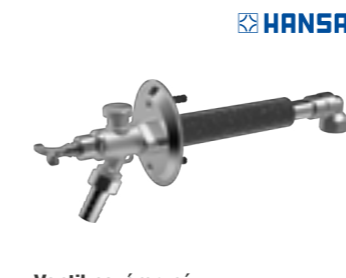
Ventil nezárzný Hansa 1/2"x450 mm vakuová pojistka, možnost zkrácení, maximální délka 450 mm, velikost připojení G1/2", pracovní tlak 0,5–10 bar, max. teplota 80 °C
