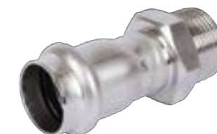
Vsvka přechodová lisovací Sanha NiroSan 9243G materiál nerezová ocel 1.4404/AISI 316L (tělo tvarovky) a 1.4408 (závitové díly, nerezové přesné odlitky) těsnění EPDM, určené pro instalace pitné vody a topení, konce na vnitřní lisování a vnější závit
