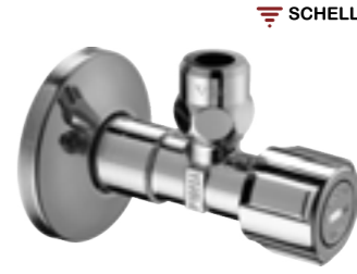
Ventil rohový Schell Comfort s filtrem a výstupem 3/8" pro měděné trubky průměru 10mm, samotěsnící závit (ASAG easy), materiál hygienicky nezávadná mosaz, povrch chrom, velikost připojení 1/2"x3/8"
