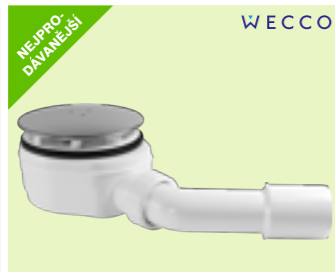
Sifon vaničkový Wecco snížený pro sprchové vaničky s odtokovým otvorem 90 mm, krytka nerez, jmenovitá světlost DN 40/50, výška těla sifonu 61 mm
