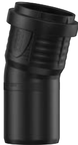
Koleno Master 3 Plus třívrstvé odpadní potrubí, materiál polypropylen kopolymer (PP-CO) a minerálně obohacený polypropylen (PP-MV), k odvodu odpadních vod v prostorech s požadavky na odhlučnění
