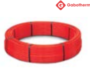
Trubka polybutenová Gabotherm Hetta 17×2,0 mm trojnásobně koextrudovaný polybuten s kyslíkovou bariérou uprostřed stěny, ø 17 mm, tloušťka 2 mm, balení 240 m
