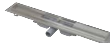
Žlab sprchový nerezový Alca APZ 6 s okrajem pro plný rošt, materiál nerezová ocel 2 mm AISI 304, vodorovný odtok, velikost přípojení DN 50, stavební výška 110–168 mm
