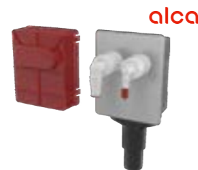
Sifon pračkový podomítkový Alca APS6 k připojení dvou spotřebičů, kolínko 17–23 mm, kolínko 8–16 mm, materiál polypropylen, kryt nerez, velikost připojení DN 40/50
