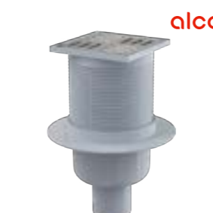
Vpust podlahová Alca APV32 spodní, mřížka z nerezové oceli, kombinovaná zápachová uzávěra Smart, rozměry 105x105/50mm
