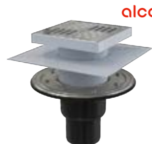
Vpust podlahová Alca APV4444 spodní, mřížka, příruba a límec z nerezové oceli, vodní a suchá zápachová uzávěra, rozměry 150x150/50/75mm
