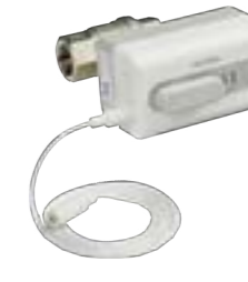
Ventil uzavírací s pohonem Resideo Braukmann L5 sestava pro automatické uzavření přívodu vody při zjištění netěsnosti nebo zamrznutí, ventil lze ovládat ručně nebo pomocí mobilní aplikace, k ventilu lze bezdrátově připojit až 30 detektorů, délka kabelu 1,5 m
