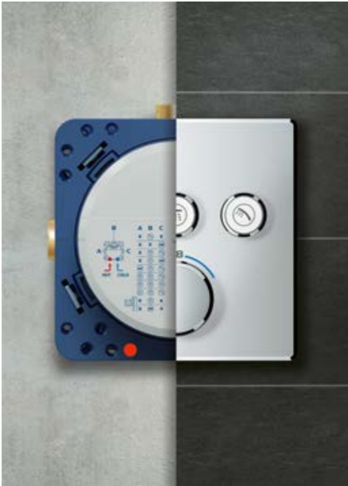
Těleso základní Grohe Rapido Smartbox 35600000 2 vstupy a 3 výstupy, velikost připojení DN 15, instalační hloubka 75–105 mm
