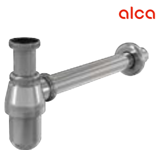
Sifon umyvadlový Alca A431 celokovový, materiál pochromovaná mosaz, převlečná matice 5/4", DN 32
