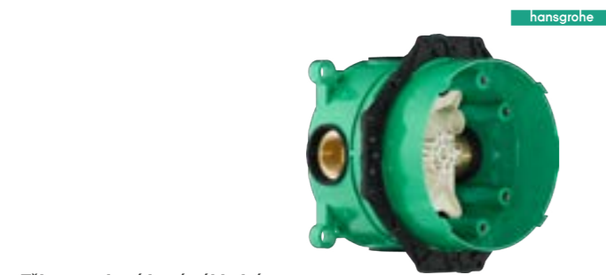
Těleso podomítkové základní Hansgrohe iBOX 01800180 2 vstupy a 2 výstupy, velikost připojení DN 20, instalační hloubka 80–108 mm
