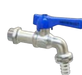
Kohout kulový zahradní Antifrost mosazný zahradní kulový kohout s pákou, speciální koule zabráňuje roztrhnutí kulového ventilu tlakem zmrzlé vody
