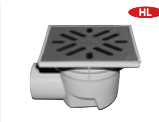
Vtok dvorní velkokapacitní HL605 vodorovný odtok s plastovým rámem 244x244mm a litinovou mříží 226x226mm, odkalovací koš a suchá klapka proti pronikání zápachu, DN 100
