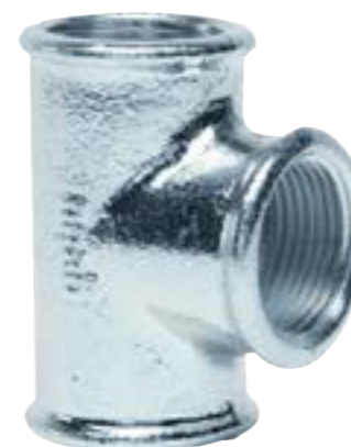
T-kus pozinkovaný č. 130 tvarovka z temperované litiny, žárově zinkováváno, vnitřní trubkový kuželový závit
