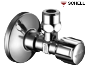
Ventil rohový Schell Comfort bez filtru a s výstupem 3/8" pro měděné trubky průměru 10mm, samotěsnící závit (ASAG easy), materiál hygienicky nezávadná mosaz, povrch chrom, velikost připojení 1/2"x3/8"
