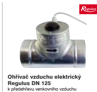
Ohřivač vzduchu elektrický Regulus DN 125 k přehřevu venkovního vzduchu a zamezení zamrznutí výměníku, s provozním a havarijním termostatem, topným tělesem s kabeláží, jmenovitý výkon 400W, jmenovitý proud 1,7A, připojovací ø 125 mm
