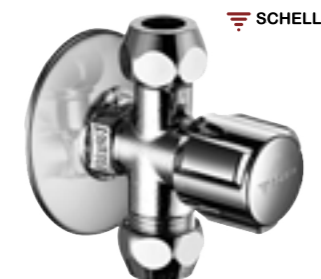
Ventil rohový Schell Comfort se dvěma 3/8" výstupy pro měděné trubky průměru 10 mm, materiál hygienicky nezávadná mosaz, povrch chrom, velikost připojení 1/2"x3/8"x3/8"
