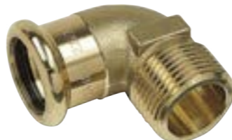
Koleno 90° lisovací Sanha Cu Purapress 8092G přechodové lisovací tvarovky z bezolovnaté křemíkaté bronzi CuSi ke spojení měděných trubek, určené na rozvody topení, konce na vnitřní lisování a vnější závit
