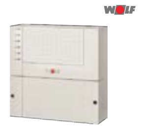
Modul kaskádový Wolf KM-2 pro řízení kaskády až 4 kotlů s modulovanými stupni hořáků nebo až 5 kotlů se spinárními stupni hořáků, nutný u všech instalací s hydraulickým oddělovačem nebo akumulátorem tepla pro více zdrojů
