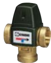
Ventil termostatický plnicí Esbe VTC 310 k ochraně kotlů před nízkou teplotou ve zpátečce, proti nízkoteplotní korozi a k efektivnímu plnění akumulčních nádob
