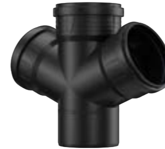
Odbočka rohová Master 3 Plus třívrstvé odpadní potrubí, materiál polypropylen kopolymer (PP-CO) a minerálně obohacený polypropylen (PP-MV), k odvodu odpadních vod v prostorech s požadavky na odhlučnění
