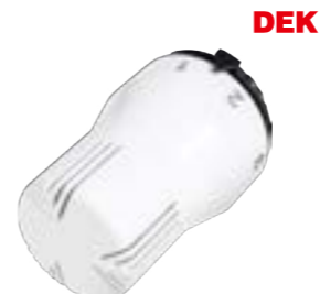
Hlavice termostatická DEK TRV1 vestavěné čidlo, kapalinová náplň, stupnice 0-5, ochrana proti zamrznutí, rozsah nastavení od 6°C do 29°C, barva bílá, závit M30×1,5 mm
