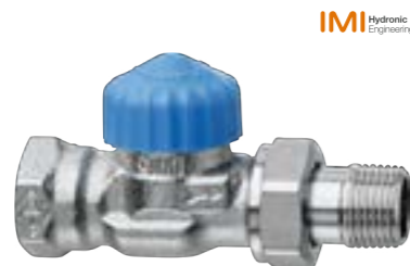
Kohout radiátorový max. provozní teplota 110°C, max. provozní tlak 6 bar
