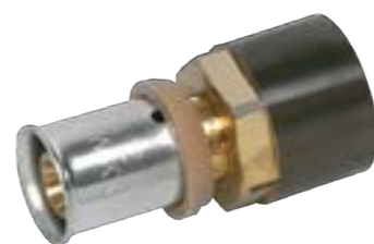
Přechodka Sanha 3fit-Press tvarovky z křemíkaté bronzi CuSi a PPSU, určené pro vícevrstvé trubky v rozvodech topení, konce na vnitřní lisování s vnitřním závitem
