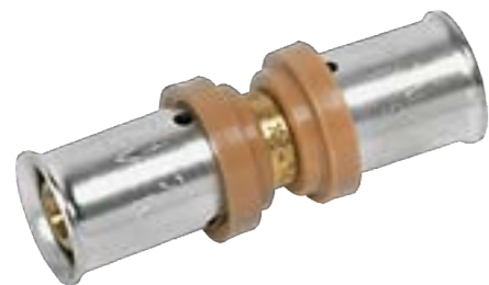
Spojka Sanha 3fit-Press tvarovky z křemíkaté bronzi CuSi a PPSU, určené pro vícevrstvé trubky v rozvodech topení, konce na vnitřní lisování
