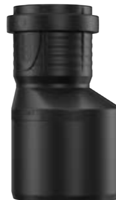
Redukce Master 3 Plus třívrstvé odpadní potrubí, materiál polypropylen kopolymer (PP-CO) a minerálně obohacený polypropylen (PP-MV), k odvodu odpadních vod v prostorech s požadavky na odhlučnění
