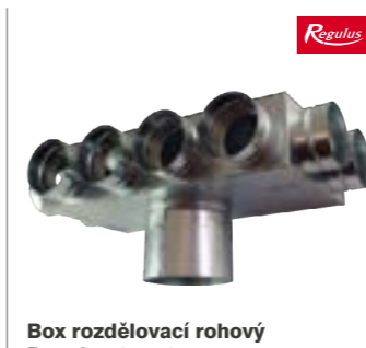
Box rozdělovací rohový Regulus 2+4+2 propojovací díl až 8 větví potrubí průměru 75 mm s páteřním vedením průměru 125 mm, se změnou směru
