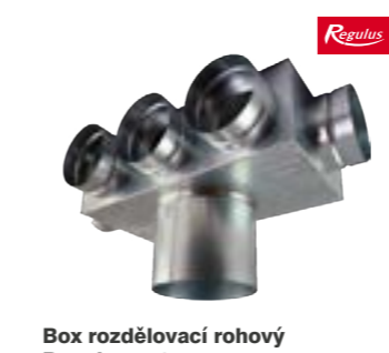
Box rozdělovací rohový Regulus 1+3+1 propojovací díl až 5 větví potrubí průměru 75 mm s páteřním vedením průměru 125 mm, se změnou směru
