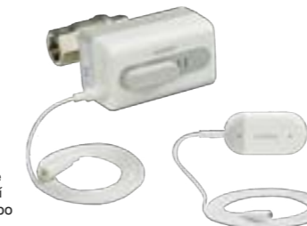
Ventil uzavírací s pohonem Resideo Braukmann L5 sestava pro automatické uzavření přívodu vody při zjištění netěsnosti nebo zamrznutí, ventil lze ovládat ručně nebo pomocí mobilní aplikace, k ventilu lze bezdrátově připojit až 30 detektorů, délka kabelu 1,5 m
