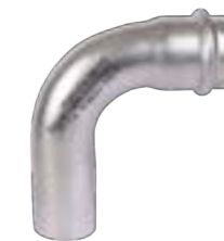
Oblouk 90° lisovací Sanha NiroSan 9001A materiál nerezová ocel 1.4404/AISI 316L (tělo tvarovky) a 1.4408 (závitové díly, nerezové přesné odlitky) těsnění EPDM, určené pro instalace pitné vody a topení, konce na vnitřní a vnější lisování
