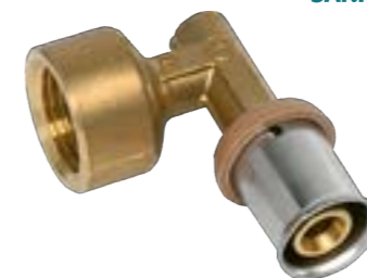
Koleno 90° Sanha 3fit-Press tvarovky z křemíkaté bronzi CuSi a PPSU, určené pro vícevrstvé trubky v rozvodech topení, konce na vnitřní lisování s vnitřním závitem
