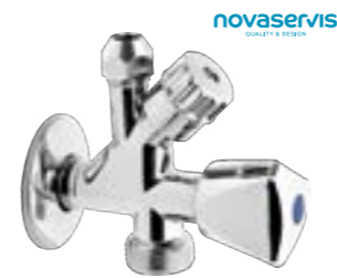
Ventil kombinovaný Novaservis CF5104 s výstupem 3/8" pro měděné trubky průměru 10 mm a zpětnou klapkou, materiál hygienicky nezávadná mosaz, povrch chrom, velikost připojení 1/2"x3/4"x3/8"
