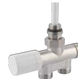
Ventil termostatický jednovtokový max. provozní teplota 100°C, max. pracovní tlak 10 bar, rozteč 50 mm, 1/2"x3/4" EK
