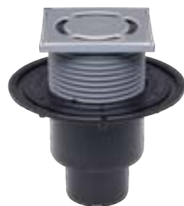
Vpust podlahová HL310N svislý odtok DN 50/75/100, s pevným izolačním límcem, vodní zápachová uzávěra 50mm, materiál PP, PE, nerezová ocel V2A, mřížka nerezová 115x115mm
