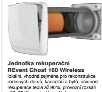
Jednotka rekuperační REvent Ghost 160 Wireless lokální, vhodná zejména pro rekonstrukce rodinných domů, kanceláří a bytů, účinnost rekuperace tepla až 90 %, provozní rozsah -30 -50 °C, maximální průtok vzduchu 60 m³/h, napětí 230V, umožňuje bezdrátové manuální nebo automatické ovládání
