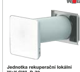
Jednotka rekuperační lokální Wolf CWL-D-70 vyjímatelný výměník tepla, letní bypass, protizamrazová ochrana, hlášení výměny filtrů, ø 250 mm
