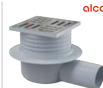
Vpust podlahová Alca APV26 boční, snížená výška, vodní zápachová uzávěra, rozměry 105x105/50mm
