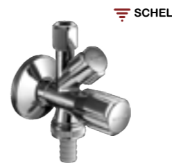
Ventil kombinovaný Schell Comfort s výstupem 3/8" pro měděné trubky průměru 10 mm a 3/4" s šroubením na hadici průměru 14 mm, materiál hygienicky nezávadná mosaz, povrch chrom, velikost připojení 1/2"x3/4"x3/8"
