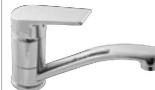
Baterie umyvadlová stojánková RAV-Slezák Colorado CO115.0 páková, umyvadlová, plná páka, keramická kartuše 35 mm, flexi připojení G3/8", povrch chrom
