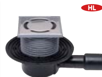
Vpust podlahová HL510NPr pevný izolační límec, sifonová vložka, plastový výškově stavitelný nástavec, rámeček 123x123mm a mřížka z nerezové oceli 115x115mm, ležatý odtok, sifonová vložka Primus, DN 40/50mm
