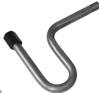
Smyčka kondenzační zahnutá KSU pracovní teplota 0–300 °C, max. provozní tlak 100 bar, levý ocelový závit G 1/2"
