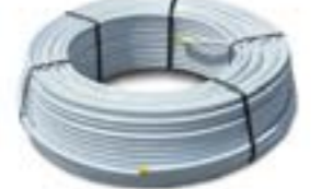
Trubka plastohliníková Gabotherm MV trubku tvoří PE-RT, adhezivní vrstva a natupo svařovaný hliník, ø 16 mm, tloušťka stěny 2 mm, 200 m/bal.
