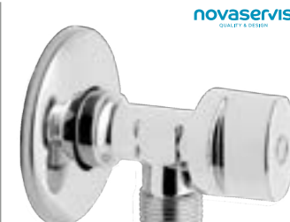
Ventil rohový Novaservis CF3009/10 bez filtru, materiál hygienicky nezávadná mosaz, povrch chrom, velikost připojení 1/2"x3/8"
