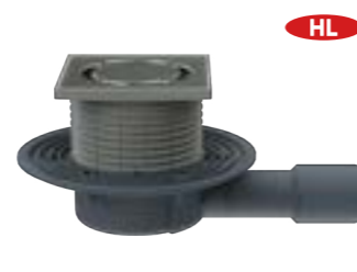
Vpust podlahová HL90Prblue ležatý odtok DN 40/50, zápachová uzávěra Primus blue kombinovaná (vodní a mechanická), pro skladby souvrství podlahy menší než 100mm, materiál polypropylen/nerezová ocel, mřížka nerezová 115x115mm
