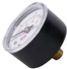
Manometr spodní se spodním připojením pro plyné a kapalné látky, které nepůsobí korozivně na části ve styku s měřenou látkou, přesnost měření třídy 1,6%
