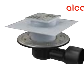
Vpust podlahová Alca APV3344 boční, mřížka, příruba a límec z nerezové oceli, vodní a suchá zápachová uzávěra, rozměry 105x105/50/75mm
