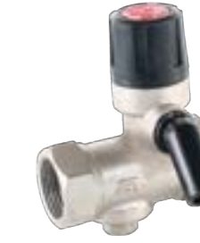
Ventil pojistný TE 2852 k ohřivačům vody, max. provozní tlak 6 bar (±0,3 bar), max. provozní teplota 90°C
