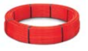
Trubka polybutenová Gabotherm Hetta 17×2,0 mm trojnásobně koextrudovaný polybuten s kyslíkovou bariérou uprostřed stěny, ø 17 mm, tloušťka 2 mm, balení 240 m
