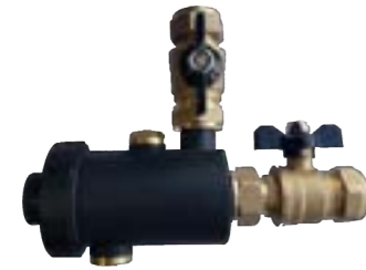
Filtr magnetický TC MF02 mini do otopných soustav, objem filtru 100ml, max. provozní tlak 10 bar, max. provozní teplota 120°C, s přípojevacím šroubením 3/4"
