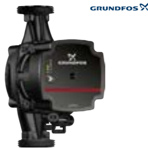
Čerpadlo oběhové Grundfos Alpha 2 elektronicky regulované, jednofázové, s funkcí AutoAdapt, vestavná délka 180 mm, napětí 230V
