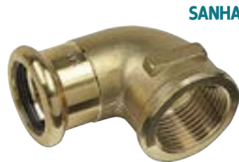
Koleno 90° lisovací Sanha Cu Purapress 8090G přechodové lisovací tvarovky z bezolovnaté křemíkaté bronzi CuSi ke spojení měděných trubek, určené na rozvody topení, konce na vnitřní lisování a vnitřní závit
