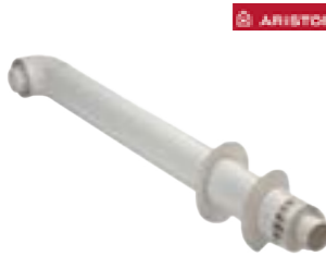
Sada horizontální Ariston DN 60/100 koncentrické odkouření pro kondenzační plynové kotle, sada obsahuje koleno 90°, objímku, koncovku a 2 kryty prostupu
