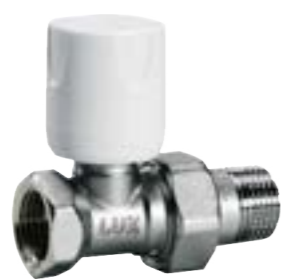
Ventil radiátorový přímý uzávěrací a regulační prvek teplovodních systémů vytápění především s nuceným oběhem vody do pracovního tlaku 10 bar
