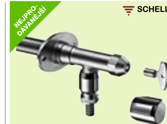
Ventil nezárzný Schell Polar II Set 1/2"x500 mm instalace stěnové průchodky během fáze hrubé stavby, sedlo ventilu je mrazuvzdorné ve zděvu pro tloušťku zdiva 200–500 mm, na nástřný klíč i rukojeť Comfort, 1/2" chrom
