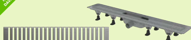
Žlab sprchový + rošt Wecco Linie s okrajem pro perforovaný rošt, materiál polypropylen, vodorovný odtok, velikost přípojení DN 40, stavební výška 66–85 mm
