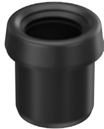
Redukce krátká Master 3 Plus třívrstvé odpadní potrubí, materiál polypropylen kopolymer (PP-CO) a minerálně obohacený polypropylen (PP-MV), k odvodu odpadních vod v prostorech s požadavky na odhlučnění
