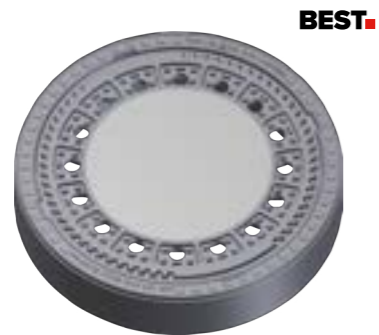
Poklop šachtový BEST KDB poklop D400 bez pantu, horizontální PUR tlumící vložka na rámu, bez pružinového zajištění víka v rámu, rozměry (průměr×výška) 785×160 mm
