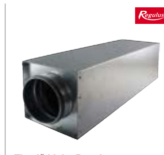
Tlumič hluku Regulus doporučuje se instalovat, pokud je délka hadice od jednotky k nejbližší vyústce méně než 3 m, pro ø 125 mm
