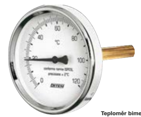
Teploměr bimetalový rozsah měření 0–120 °C, přesnost třídy 2%, G 1/2"
