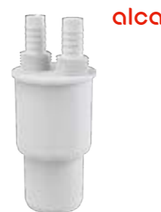
Redukce napojení HT Alca AKS6 materiál polypropylen, šroubení G 1/2", napojení hadice 14 mm, DN 40/50
