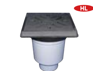
Vtok dvorní velkokapacitní HL606.1/1 svislý odtok s litinovým rámem 260x260mm a litinovou mříží 226x226mm, odkalovací koš, suchá klapka proti pronikání zápachu, DN 110
