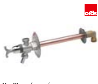
Ventil nezárzný Oras 1/2"x1000 mm vakuová pojistka, možnost zkrácení, maximální délka 1 000 mm, velikost připojení G1/2", pracovní tlak 0,5–10 bar, max. teplota 80 °C
