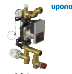
Stanice regulační Uponor Fluvia T Push-23-B-W s elektronickým čerpadlem Wilo Yonos Para 15/6 RKA (průtok 0,1–2,5 m³/h, EEI 0,17), termostat s kapilárními snímačem v rozmezí 20–55 °C, max. teplota na vstupu 90 °C, max. teplota na výstupu 55 °C, max. provozní tlak 10 bar
