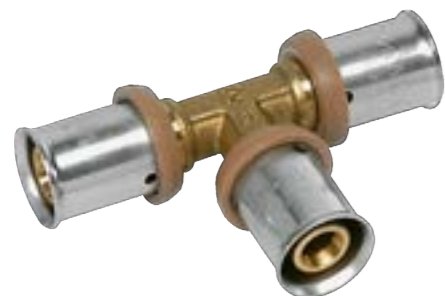
T-kus Sanha 3fit-Press tvarovky z křemíkaté bronzi CuSi a PPSU, určené pro vícevrstvé trubky v rozvodech topení, konce na vnitřní lisování
