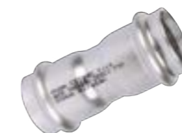
Nátrubek lisovací Sanha NiroSan 9270 materiál nerezová ocel 1.4404/AISI 316L (tělo tvarovky) a 1.4408 (závitové díly, nerezové přesné odlitky) těsnění EPDM, určené pro instalace pitné vody a topení, konce na vnitřní lisování
