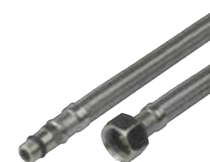
Hadice flexi voda KZ300 FF korugovaná hadice, otočná převlečná matice, ploché pryžové těsnění pro styk s pitnou vodou, max. provozní tlak 5 bar, provozní teplota -15 °C až 90 °C, závit FF
