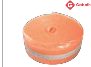
Pás dilatační Gabotherm GTF-RDS z pěnového polyetylenu, k dilatování potěrů, s jednostranným přesahem a samolepicím pruhem, výška 150 mm, tloušťka 8 mm, délka 25 m
