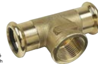
T-kus lisovací Sanha Cu Purapress 8130G přechodové lisovací tvarovky z bezolovnaté křemíkaté bronzi CuSi ke spojení měděných trubek, určené na rozvody topení, konce na vnitřní lisování a vnitřní závit
