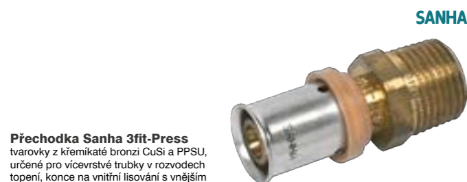
Přechodka Sanha 3fit-Press tvarovky z křemíkaté bronzi CuSi a PPSU, určené pro vícevrstvé trubky v rozvodech topení, konce na vnitřní lisování s vnitřním závitem
