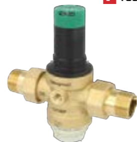
Ventil redukční Resideo Braukmann D06F se šroubením, manometr, max. teplota vody 40 °C, max. vstupní tlak 16 bar, výstupní tlak 1,5–6 bar
