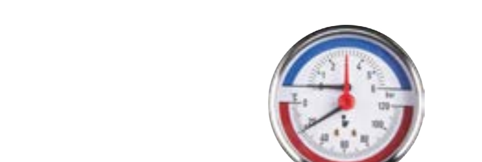
Termomanometr ø budíku 80 mm, rozsah měření 0–120 °C, třída přesnosti 1,6%, G 1/2"
