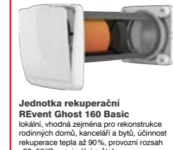
Jednotka rekuperační REvent Ghost 160 Basic lokální, vhodná zejména pro rekonstrukce rodinných domů, kanceláří a bytů, účinnost rekuperace tepla až 90 %, provozní rozsah -30 -50 °C, maximální průtok vzduchu 60 m³/h, napětí 230V, umožňuje manuální ovládání na poloviční nebo plný výkon
