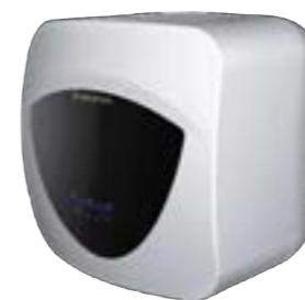
Ohřivač elektrický zásobníkový Ariston Elite 10U tlakový závěsný ohřivač vody, pod umyvadlo instalace, příkon 2,0kW, elektronický termostát, zátěžový profil XXS, energetická třída ohřevu vody A, objem 10l, rozměry (š×v×h) 360×360×294 mm
