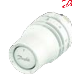
Hlavice termostatická Danfoss Redia kapalinová s integrovaným čidlem, hladké provedení, reakční doba 18 min, připojení M30×1,5, rozsah nastavení teploty 8-28°C
