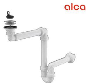
Sifon umyvadlový Alca A413 prostorově úsporný, materiál polypropylen, s nerezovou mřížkou výpusti DN 63, zátka z PVC, DN 40
