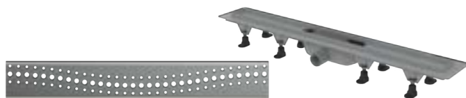
Žlab sprchový + rošt Wecco Vina s okrajem pro perforovaný rošt, materiál polypropylen, vodorovný odtok, velikost přípojení DN 40, stavební výška 66–85 mm
