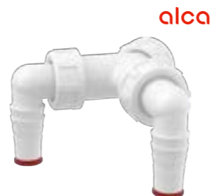
Kolínko dvojité P148Z pro napojení dvou spotřebičů, se zpětnými klapkami, připojení G 1", připojení hadic ø 17–23 mm
