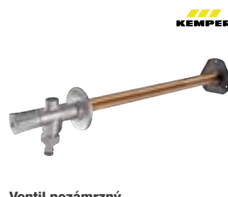
Ventil nezárzný Kemper Frosti Plus XL 1/2"x530 mm integrovaná zpětná klapka a přivzdušňování, průtok 40 l/min (1 bar), velikost připojení 1/2", stavební délka 150–530 mm
