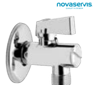
Ventil rohový Novaservis CF3010/10 s filtrem, materiál hygienicky nezávadná mosaz, povrch chrom, velikost připojení 1/2"x3/8"
