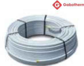
Trubka plastohliníková Gabotherm MV trubku tvoří PE-RT, adhezivní vrstva a natupo svařovaný hliník, ø 16 mm, tloušťka stěny 2 mm, 200 m/bal.
