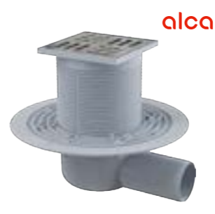
Vpust podlahová Alca APV101 boční, mřížka z nerezové oceli, vodní zápachová uzávěra, rozměry 105x105/50mm
