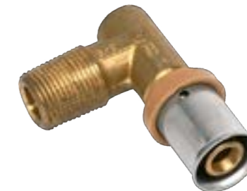
Koleno 90° Sanha 3fit-Press tvarovky z křemíkaté bronzi CuSi a PPSU, určené pro vícevrstvé trubky v rozvodech topení, konce na vnitřní lisování s vnějším závitem
