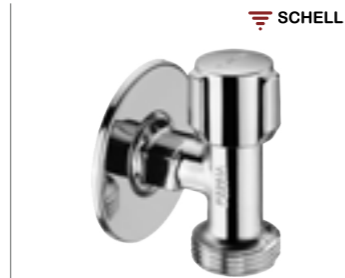
Ventil přístrojový Schell Comfort vhodný pro úsporu místa za pračkou/myčkou, materiál hygienicky nezávadná mosaz, povrch chrom, velikost připojení 1/2"x3/4"
