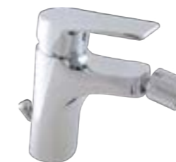
Baterie bidetová RAV-Slezák Colorado CO145.0 páková, s plnou pákou, stojánková jednoutorová, s odtokovou soupravou, keramická kartuše o průměru 35 mm KA3502, povrch chrom
