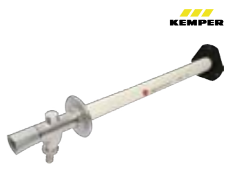
Ventil nezárzný Kemper Frosti Plus 1/2"x435 mm integrovaná zpětná klapka a přivzdušňování, průtok 40 l/min (1 bar), velikost připojení 1/2", stavební délka 150–435 mm
