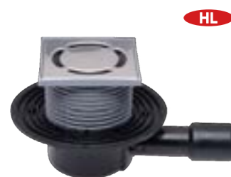
Vpust podlahová HL510N ležatý odtok DN 40/50, s pevným izolačním límcem, vodní zápachová uzávěra 50mm, materiál PP, PE, nerezová ocel V2A, mřížka nerezová 115x115mm
