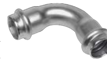
Oblouk 90° lisovací Sanha NiroSan 9002A materiál nerezová ocel 1.4404/AISI 316L (tělo tvarovky) a 1.4408 (závitové díly, nerezové přesné odlitky) těsnění EPDM, určené pro instalace pitné vody a topení, konce na vnitřní lisování
