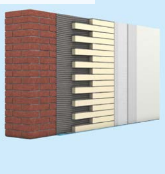
07| Skladba systému Remmers iQ Therm
