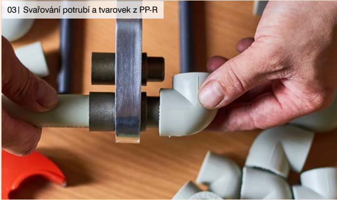
03| Svařování potrubí a tvarovek z PP-R
