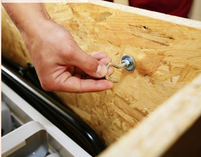
03| Osazení závitových tyčí
