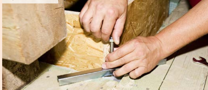
06| Nasazení rámu horního víka
