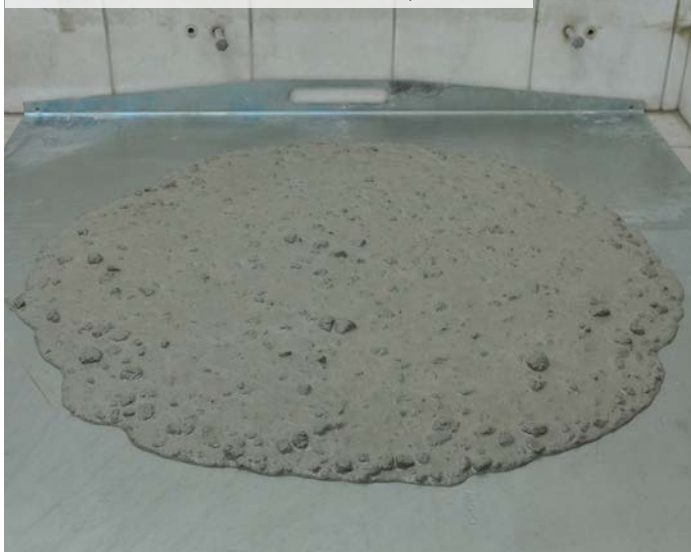
04 | Zkouška konzistence betonu rozlitím – směr s plastifikátorem
