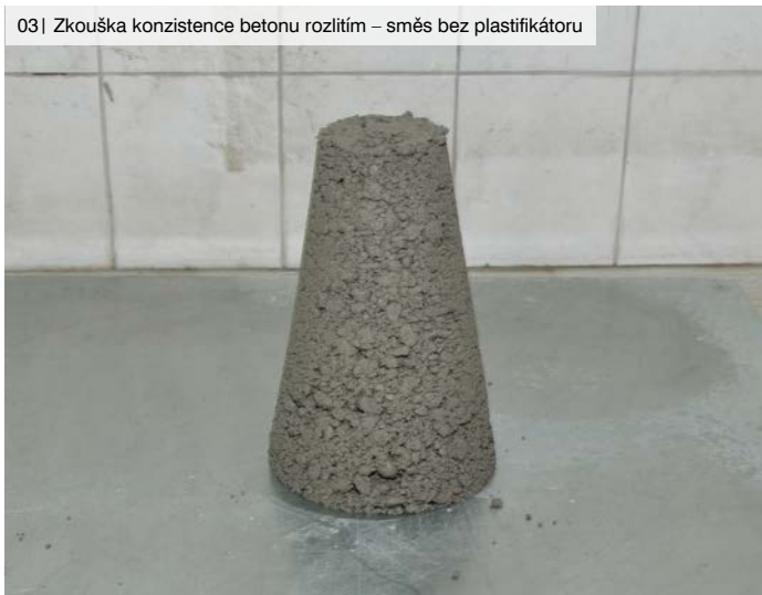
03 | Zkouška konzistence betonu rozlitem – směs bez plastifikátoru
