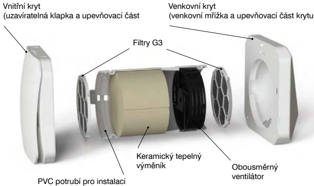
04 | Lokální větrací jednotka
