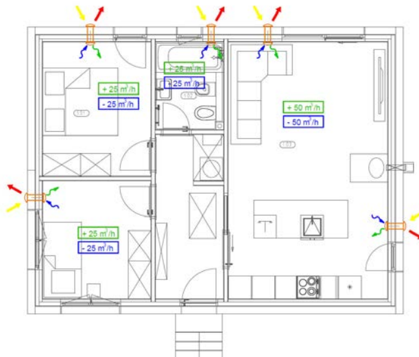
02 | Příklad návrhu větracího systému
