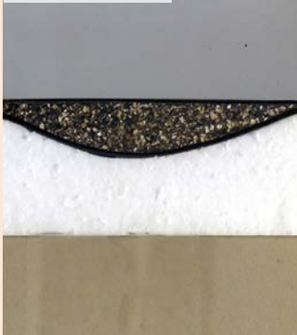
07| Příklad vyrovnání lokální nerovnosti
