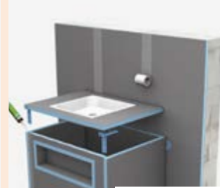
03 | Utěsnění spoje lepidlem
