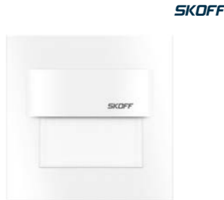
Svítilno LED s čidlem pohybu Skoff Tango podání barev CRI >80, jmenovité napětí 230V, životnost 50000h, mechanická odolnost IK 09, třída ochrany II, čidlo pohybu: dosah 3–4m, doběhový čas 3–35s, úhel činnosti 120°, citlivost 2–40lx
