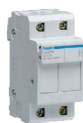
Odpínač pojistkový Hager L502PV pro fotovoltaické systémy, jmenovité napětí DC 1 000 V, jmenovitý proud 32 A, 2pól, typ pojistky gPV, velikost pojistky 10×38 mm
