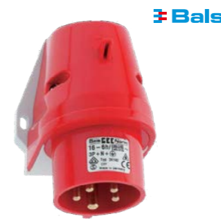
Přívodka nástěnná 5pól 400V Bals Quick Connect nástěnná montáž, otočný spodek pouzdra (o 180°), kontakty Kontex, přívod nahoře (M25) a ze zadu, jmenovité napětí 400V, 5pól, krytí IP 44, hodinový úhel 6h
