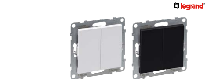
Přepínač sériový Legrand Suno řazení 5, svorky bezšroubové, jmenovitý proud 10 A
