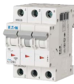
Jistič 10 kA 3pól C Eaton PL7 jmenovité napětí AC 230/400V, jmenovité napětí DC 48V, zkratová vypínací schopnost 10kA, vypínací charakteristika C, 3pól, typ napětí AC/DC, svorky šroubové
