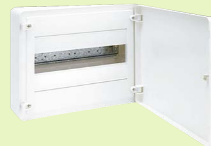
Rozvodnice Hager golf montáž nástěnná, krytí IP 40, materiál plast, třída ochrany II, mechanická odolnost IK 07, hloubka 99mm
