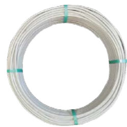
Drát zemnicí AlMgSi/PVC k nadzemní části hromosvodu, ke skrytým svodům, měkký, opláštění z PVC, materiál AlMgSi/PVC, ø8 mm, délka 100 m, hmotnost 20 kg, 5 m/kg
