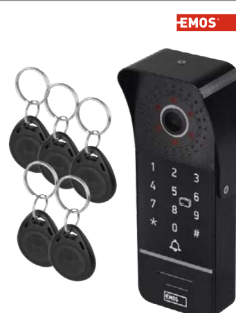
Jednotka kamerová Emos EM-10AHD KEY-1 pro monitory a videotelefony EMOS EM-10AHD, klávesnice, napájení z monitoru, požadovaná kabeláž UTP nebo SYKFY 5x2x0,5, počet vodičů 4+0+0, antivandal provedení, barevné snímání, detekce pohybu s funkcí alarmu, ovládání dveřního zámku, přísvecení kamery, 5x vstupní čip, snímací prvek kamery 2 Megapixel AHD 1080px, barva černá
