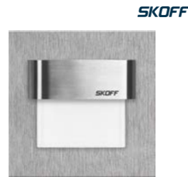
Svítilno LED Skoff Tango IP 66 včetně předradníku, podání barev CRI >80, jmenovité napětí 10V, životnost 50000h, mechanická odolnost IK 09, třída ochrany III
