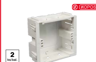
Krabice přístrojová ke kanálu Kopus PK KP 80PK_HB vyjímatelné příčky, vhodné k instalaci přístrojů v hranatém rámečku, umožňuje vložení stínicího kanálu SK 40×20, není vhodná pro přístroje se zaoblenými rohy (ABB - Tango), šířka 80,2mm, výška 71mm, hloubka 37mm
