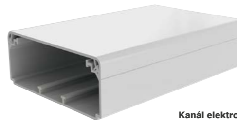
Kanal elektroinstalační Kopos EKD 100×40 ke vkládání více kabelů nebo kabelů větších průměrů, možnost vložení příčky PEKD 40, dvojitý zámek víka zvyšující tuhost kanálu a zajišťující pevnější fixaci víka, včetně rozpěrek, s ochrannou fólií, krytí IP 40, materiál PVC samozhášivý, barva bílá, šířka 100 mm, výška 40 mm
