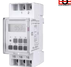
Spínač časový Elektrobock CS4-16 digitální hodiny s týdenním programem, maximální zátěž 3680W, spínací prvek relé 230V/16A, montáž na DIN lištu, záloha chodu více jak 100 hodin
