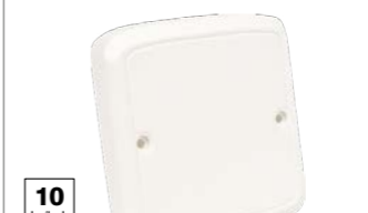
Víčko k přístrojovým krabicím kanálů Kopus LK VLK 80/T_HB k zakrytí lištových krabic LK 80×16T a LK 80×28 T, materiál PVC, samozhášivé, šířka 81mm, výška 81mm, hloubka 11mm
