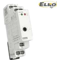
Relé hlídání napětové Elko HRN-55N k hlídání 3fázových sítí, kontroluje sled a výpadky fází, překročení hlídáního napětí, jmenovité napětí AC 400V, kontakty 1x přepínací
