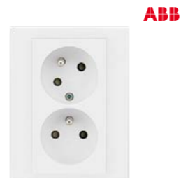
Zásuvka 230V dvojnásobná kompletní ABB Levit natočená zásuvka, clonky, svorky bezšroubové, jmenovitý proud 16 A, barva bílá
