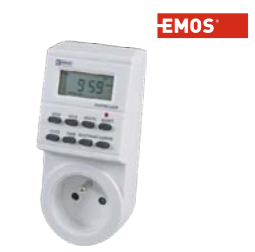
Zásuvka spínací digitální Emos P5501 jmenovité napětí 230V, vnitřní, krytí IP 20, digitální, 8 programů, maximální zátěž 3680W/16A, záložní akumulátor NiMH, 1,2V, 40 mAh, 8 spínání/den
