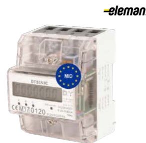
Elektroměr podružný Eleman DTS 353C 80A MID digitální číselník, jmenovitý proud 80A, 3 fáze, 1 tarif, 4,5 modulu
