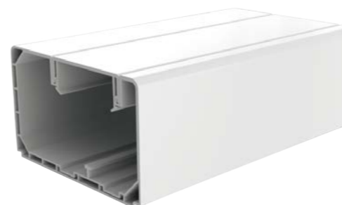
Kanal elektroinstalační Kopos PK 90×55 k instalaci modulárních přístrojů 45×45 nebo 45×22,5 mm, s ochrannou fólií, krytí IP 40, mechanická odolnost IK 07, materiál PVC samozhášivý, barva bílá, šířka 90 mm, výška 54 mm
