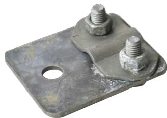
Svorka přípojovací SP1 k připojení ke konstrukci šroubem M8, pro průměr vodiče 8–10 mm, rozměry 55×70 mm, materiál FeZn
