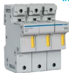
Odpínač pojistkový Hager LR603 pro válcové pojistky, jmenovitý proud 50 A, 3pól, typ pojistky C14, velikost pojistky 14×51 mm
