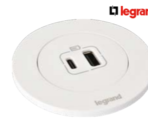
Zásuvka zapuštěná Incara Legrand Disq 60 k instalaci do nábytku, 1× nabíječka USB A a C, barva bílá, průměr výřezu 60 mm, instalace do vodorovné i svislé plochy, možná instalace i do 1 mm kovového plechu
