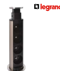
Sloupek zásuvkový nábytkový Incara Legrand Tower 60 k instalaci do nábytku, 4× 230V zásuvka, vrchní koncový kryt z nerezové oceli, průměr výřezu 60–65 mm, včetně napájecího kabelu s vidlicí
