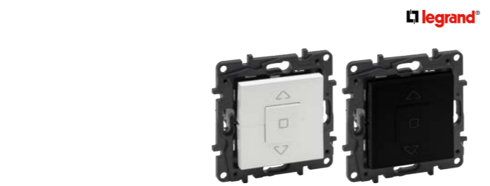
Spínač žaluziový Legrand Niloé Step řazení 1+1 s blokadí, svorky bezšroubové, jmenovitý proud 6A
