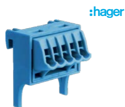
Svorkovnice k chráničům bezšroubová Hager N k proudovým chráničům, jednopólová, pro 5 vodičů, barva modrá, šxvx 27x35x30 mm
