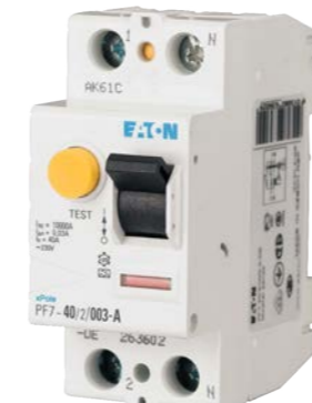
Chráníč proudový 10 kA typ A 300 mA Eaton PF7 zkratová vypínací schopnost 10kA, jmenovitý reziduální proud 300mA, citlivost na reziduální proud A, svorky šroubové
