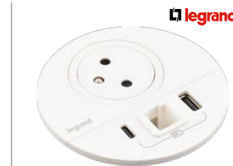
Zásuvka zapuštěná Incara Legrand Disq 80 k instalaci do nábytku, 1× zarovnaná 230V zásuvka, 1× nabíječka USB A a C, 1× vývod datový kabelový RJ45 C6 FTP, barva bílá, průměr výřezu 80 mm, včetně kabelu s vidlicí
