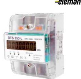
Elektroměr podružný Eleman DTS 353-L 80A digitální číselník, jmenovitý proud 80A, 3 fáze, 1 tarif, 5 modulů
