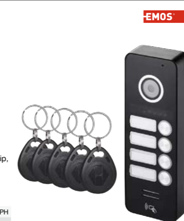
Jednotka kamerová Emos EM-10AHD RF-4 pro monitory a videotelefony EMOS EM-10AHD, 4 vstupní tlačítka, 5x vstupní čip, požadovaná kabeláž FTP nebo SYKFY 5x2x0,5, antivandal provedení, detekce pohybu s funkcí alarmu, ovládání dveřního zámku, přísvecení kamery
