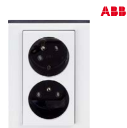
Zásuvka 230V dvojnásobná kompletní ABB Levit natočená zásuvka, clonky, svorky bezšroubové, jmenovitý proud 16 A, barva bílá, kouřová černá
