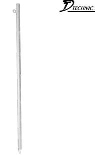
Tyč zemnicí se svorkou ZTT svorka SR 03K k připojení kruhového zemnicího vodiče, T profil, rozměry 30x4 mm, materiál FeZn
