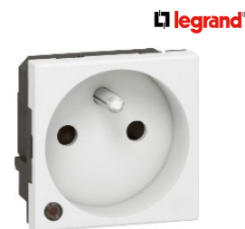
Zásuvka 230V jednonásobná Legrand Mosaic přepětová ochrana, svorky bezšroubové, jmenovitý proud 16A, barva bílá, 2 moduly
