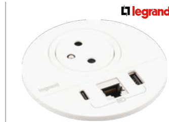
Zásuvka zapuštěná Incara Legrand Disq 80 k instalaci do nábytku, 1× zarovnaná 230V zásuvka, 1× nabíječka USB A a C, 1× zásuvka datová RJ45 C6 FTP, barva bílá, průměr výřezu 80 mm, včetně kabelu s vidlicí
