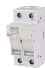
Odpínač pojistkový ETI EFH 10DC 2p pro fotovoltaické instalace, kategorie použití DC-20B, jmenovité napětí DC 1 000 V, jmenovitý proud 25 A, 2pól, velikost pojistky 10×38 mm
