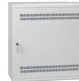
Rozvaděč datový nástěnný 19" Solarix LC-18 k instalaci prvků síťových kabeláží a telekomunikačních prvků, pevný skelet, dveře s kovovým zámekem, perforace pro větrání, krytí IP 20, šířka 540 mm, hloubka 180 mm, výška 540 mm (6U), dveře plechové, hmotnost 7,5 kg
