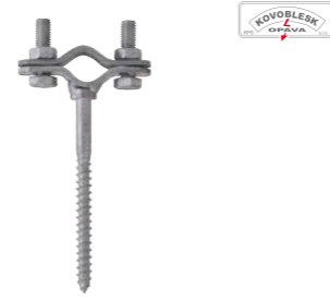
Držák ochranného úhelníku DUD do zdíva a dřeva, k upevnění ochranného úhelníku k chráněnému objektu pomocí vrutu M6, M8 a hmoždinek, ø8 mm, materiál FeZn
