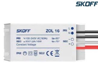
Transformátor pro LED osvětlení Skoff vstupní napětí 100–250V AC/50Hz, výstupní napětí 10V DC, proud 1,6A, výkon 16W, SELV, krytí IP 68, třída ochrany II
