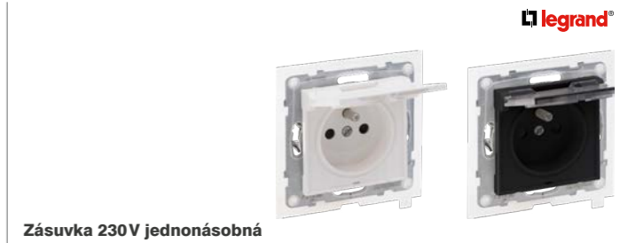
Zásuvka 230V jednonásobná Legrand Suno clonky, víčko, svorky bezšroubové, jmenovitý proud 16 A, krytí IP 44
