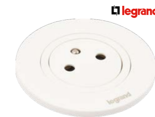
Zásuvka zapuštěná Incara Legrand Disq 60 k instalaci do nábytku, 1× zarovnaná 230V zásuvka, barva bílá, průměr výřezu 60 mm, instalace do vodorovné i svislé plochy, možná instalace i do 1 mm kovového plechu
