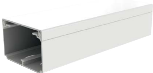
Lišta hranatá Kopos LH 60×40 s ochrannou fólií, krytí IP 40, mechanická odolnost IK 06, materiál PVC samozhášivý, barva bílá, šířka 60 mm, výška 40 mm
