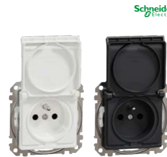
Zásuvka 230 V jednonásobná Schneider Electric Sedna Design svorky bezšroubové, jmenovitý proud 16A, krytí IP 44
