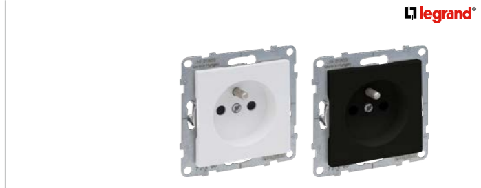
Zásuvka 230V jednonásobná Legrand Suno clonky, přepěťová ochrana, svorky bezšroubové, jmenovitý proud 16 A
