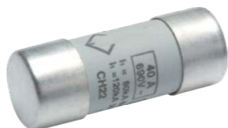
Vložka pojistková Hager 22×58 typ napětí AC, zkratová vypínací schopnost 120kA, vypínací charakteristika gG
