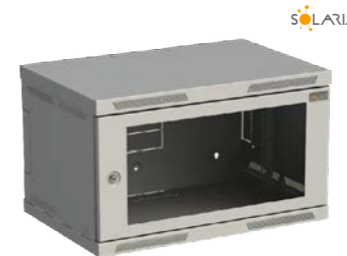
Rozvaděč datový nástěnný 19" Solarix Sensa dveře se zámek, perforace pro odvětrání, krytí IP 20, barva šedá RAL 7035, šířka 600 mm, hloubka 400 mm
