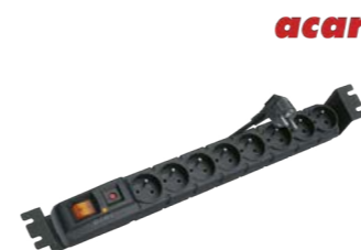
Panel napájecí Acar S8FA s přepětovou ochranou, 8 zásuvek, automatický jistič 10A, jmenovitě napětí 250 V, jmenovitý proud 10A, Up 1,3 kV, materiál samozhášecí plast, rozměry 445x54x55 mm
