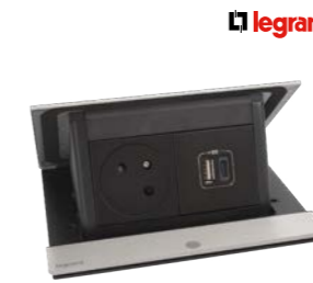
Krabice PopUp Legrand Incara 1× zásuvka 230V, USB nabíječka A+C, barva broušený hliník, montážní otvor 107×129 mm, krytí IP 20, mechanická odolnost IK 07, šířka 125 mm, hloubka 5,2 mm
