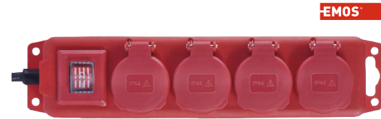
Kabel prodlužovací gumový 4zásuvka Emos clonky, vypínač, USB nabíjení, jmenovité napětí 230V, jmenovitý proud 16A, maximální zatížení 3680W, typ vodiče H07RN-F3G, průřez vodiče 1,5mm 2 , izolační materiál guma, neopren, barva černá, červená, délka 3m
