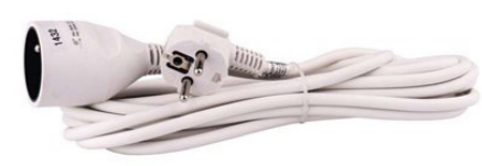
Kabel prodlužovací PVC spojka Emos max. zátěž 2300W, vodič H05VV-F 3G 1mm 2 , jmenovitý proud 10A, napětí 250V, barva bílá
