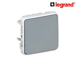
Přepínač střídavý Legrand Plexo řazení 6, svorky bezšroubové, jmenovitý proud 10A, barva šedá, krytí IP 55
