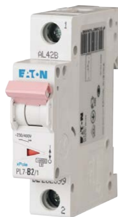
Jistič 10 kA 1pól B Eaton PL7 jmenovité napětí AC 230/400V, jmenovité napětí DC 48V, zkratová vypínací schopnost 10kA, vypínací charakteristika B, 1pól, typ napětí AC/DC, svorky šroubové
