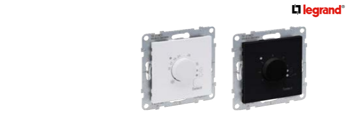
Termostat otočný prostorový Legrand Suno vhodný k ovládní stropního a podlahového topení, regulace 5–30°, svorky šroubové
