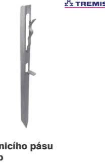
Držák ochranné trubky a jímače DOT UNI k upevnění ochranné trubky a jímacích tyčí k chráněnému objektu pomocí kombinovaného vrut/šroubu M8 a hmoždinek, materiál FeZn
