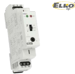
Automat schodišťový s manuálním ovládním Elko CRM-4/230V jmenovitý proud 16A, jmenovité napětí AC 230 V, kontakty 1x přepínací
