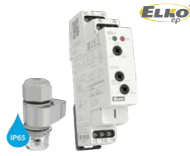
Spínač soumrakový analogový s fotosenzorem Elko SOU-1 fotosenzor SKS-100/230V, nastavitelná úroveň osvětlení ve dvou rozsazích: 1-100lx a 100-50000lx, výstupní kontakt 1x přepínací 16A, stav výstupu indikuje červená LED
