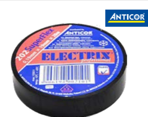
Páska elektroinstalační Anticor 202 Electrix Superflex Ize použit k mechanické ochraně petrolátové pásky 701-40 a k elektrické izolaci kabelů nízkého napětí i pod zemí, elastická, samozhášivá, materiál PVC, barva černá, šířka 25 mm, délka 20 m, tloušťka 0,19 mm
