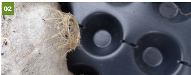
Prokořenění skrz celou tloušťku substrátu po 75 dnech po realizaci
