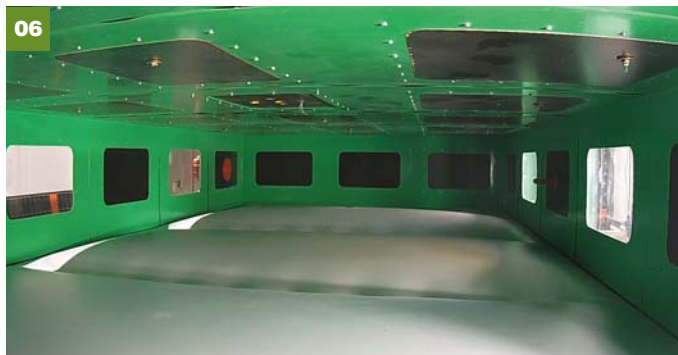
Zkouška fóliové hydroizolace ve vakuové komoře
