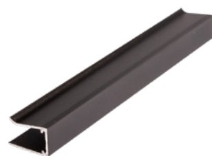
Profil U ukončovací hliníkový elox bronz 10 mm k ukončení PC desek tl. 10 mm na okapní hraně, tvar U, materiál hliník, povrchová úprava elox, barva bronz, tloušťka desky 10 mm, délka 6 m
