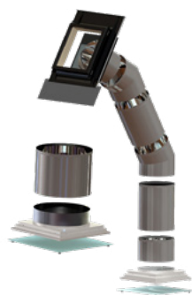
Světlovod SUNIZER SQUARE základní sada pro šikmou/plochou střechu, hranatý difuzor, kryt difuzoru KRIZET, součinitel prostupu tepla 1 W.m -2 .K -1
