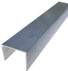
Profil U ukončovací se zobáčkem hliníkový elox 32 mm k ukončení PC desek tl. 32 mm na okapní hraně, tvar U se zobáčkem, materiál hliník, povrchová úprava elox, tloušťka desky 32 mm, délka 6,4 m
