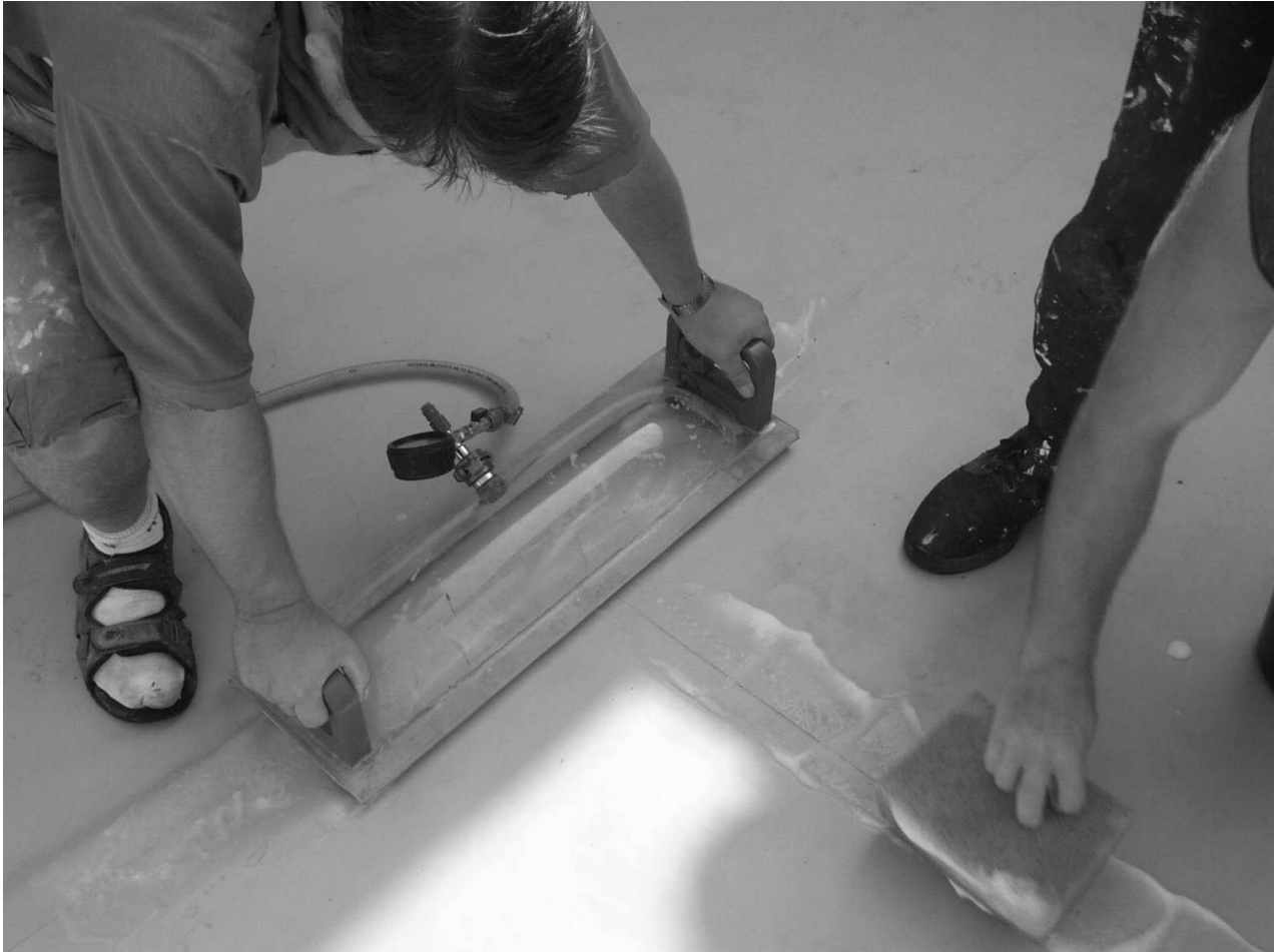
Obrázok 26: Skúšanie tesnosti spojov vákuovou skúškou
