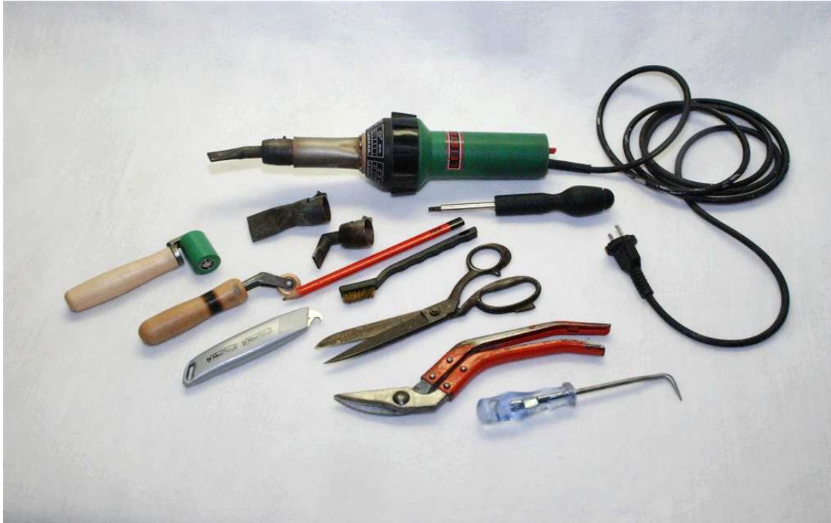
Obrázok 4: Základné nástroje k realizácii hydroizolácií z fólií ALKORPLAN
