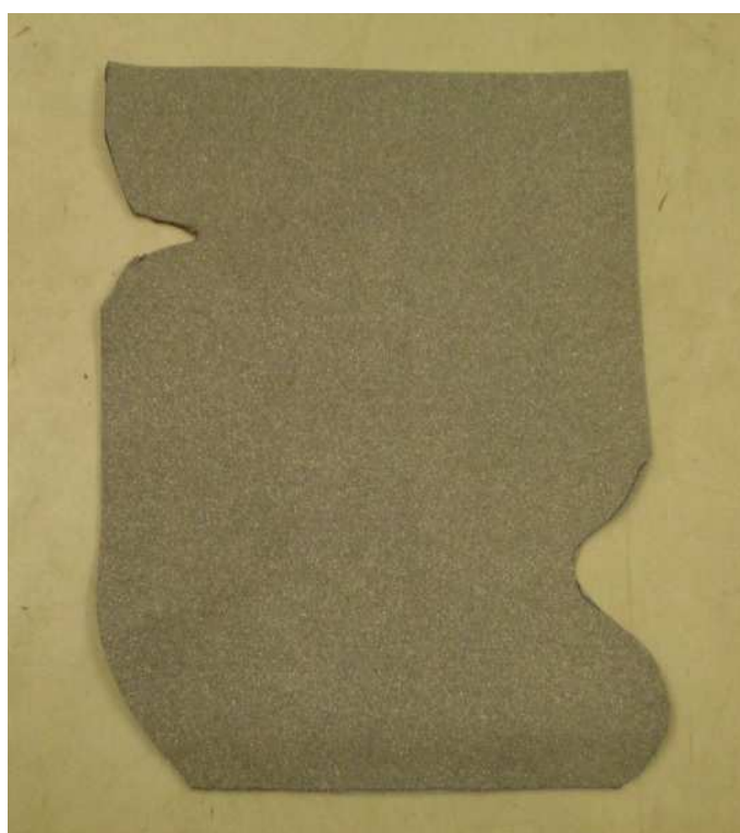
Obrázok /18/ Špeciálny tvar asfaltovaného pásu na atike medzi vnútorným kútom a vonkajším rohom
