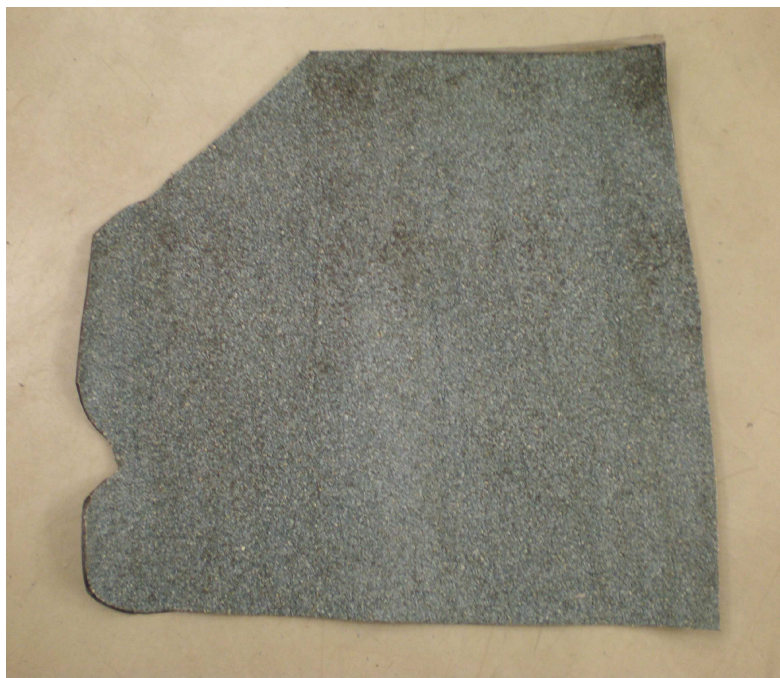
Obrázok /22/ Špeciálny tvar asfaltovaného pásu s posypom privedeného po atike k detailu vonkajšieho rohu
