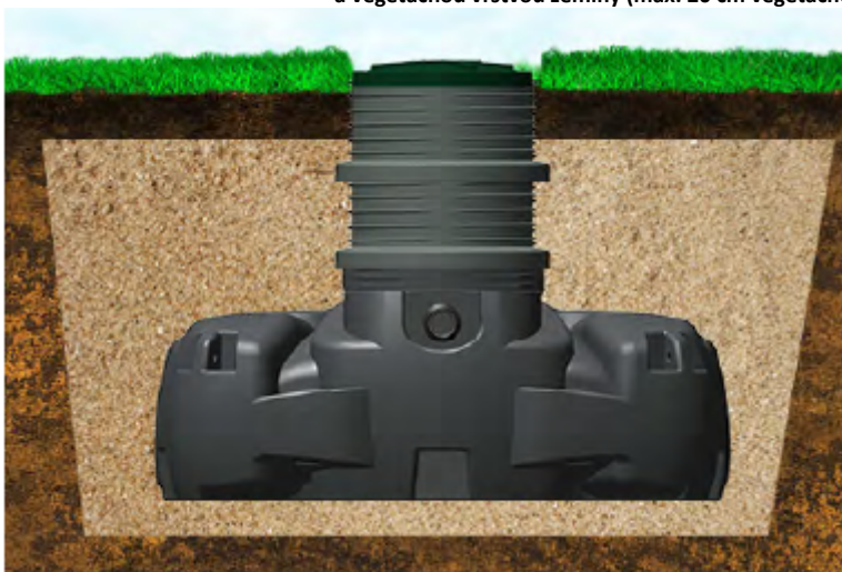
Inštalácia s maximálne dvoma predĺžovacími nadstavcami: zasypanie pieskom a vegetačnou vrstvou zeminy (max. 20 cm vegetačnej vrstvy zeminy)
