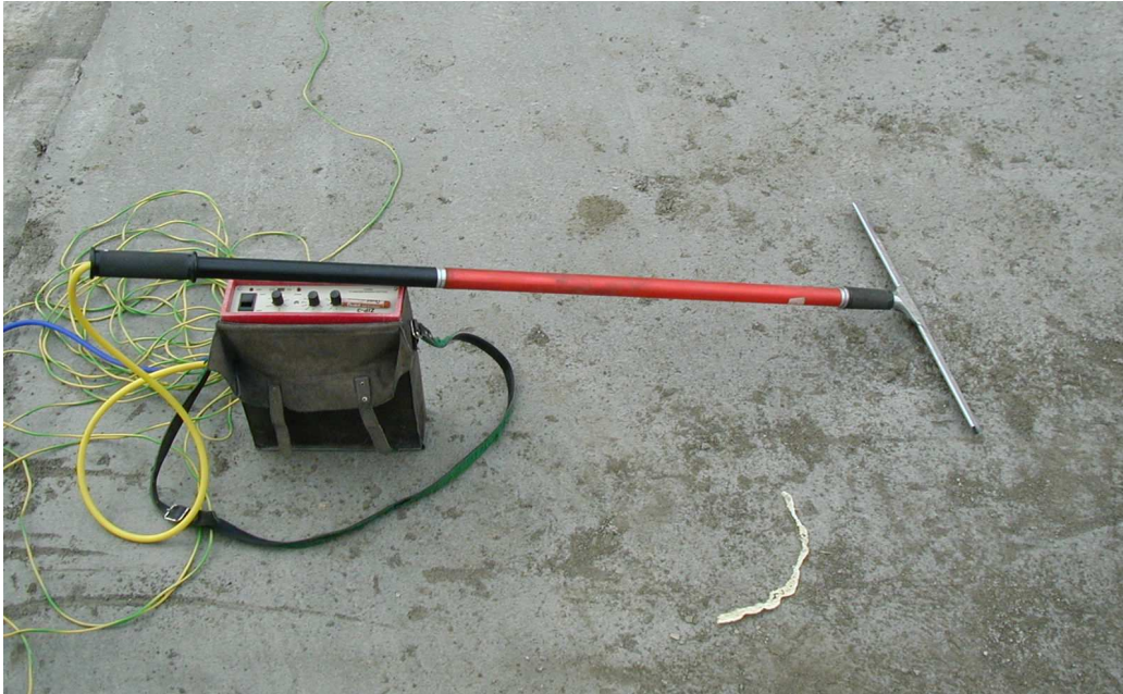
Foto 8. Poroskop - prístroj pre realizáciu iskrovej skúšky.
