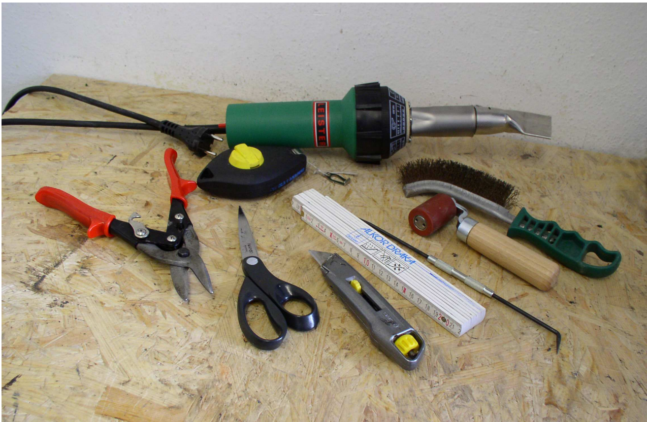
Foto 2. Nástroje pre montáž fóliových systémov.
