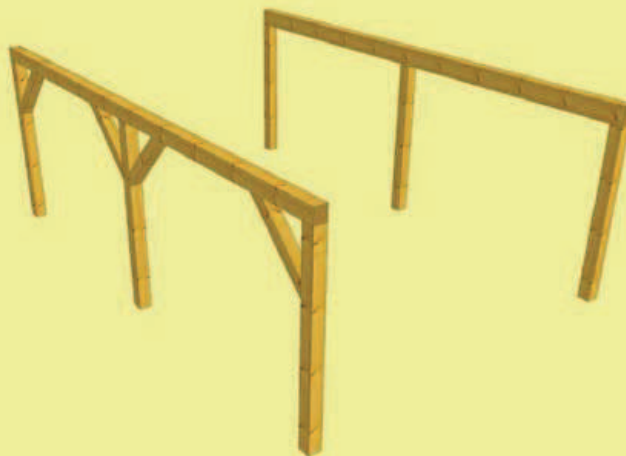
11 | Rozdíl v dimenzích vaznic s podepřením pásky a bez pásků. Dimenze vaznice s pásky 140 x 200 mm, dimenze vaznice bez pásků v pravo 140 x 280 mm
