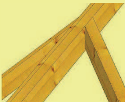
06 | Styk krokve na nárožní krokev a) klasické lípnutí
