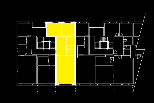
Obr. 09 | Půdorys objektu bytového domu s posuzovaným bytem
