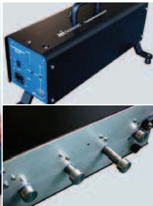
01 | Zvukoměr 02 | Zdroj kročejového zvuku 03 | Detail zdroje kročejového zvuku
