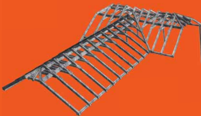
3D prostorový model konstrukce krovu
