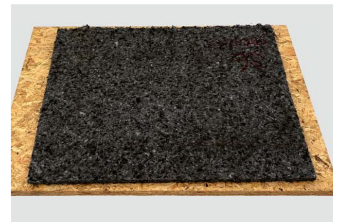
Obr. 1: Stav hydroakumulačních desek po 3,5 letech od realizace vegetační skladby
