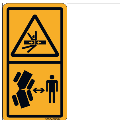
Obr. 17: Oblast kloubového spoje
