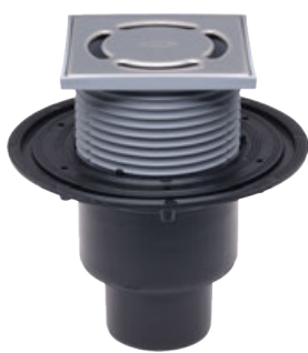
Vpust podlahová HL310N svislý odtok DN 50/75/110, s pevným izolačním límcem, vodní zápachová uzávěra 50 mm, materiál PP, PE, nerezová ocel V2A, mřížka nerezová 115×115 mm
