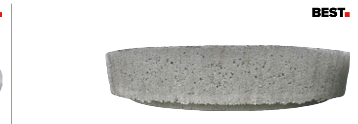
Poklop pro studny BEST TBN-Q 800/C zákrytová deska z betonu třídy C35/45, celistvý poklop s ozubem, ø 950 mm, výška 150 mm
