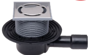
Vpust podlahová HL510N ležatý odtok DN 40/50, s pevným izolačním límcem, vodní zápachová uzavěra 50 mm, materiál PP, PE, nerezová ocel V2A, mřížka nerezová 115×115 mm
