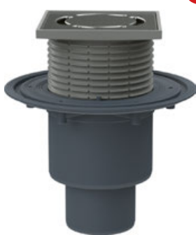
Vpust podlahová HL310Prblue svislý odtok DN 50/75/110, s pevným izolačním límcem, zápachová uzavěra Primus blue (suchý sifon), materiál PP, PE, nerezová ocel, mřížka nerezová 115×115 mm
