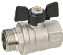
Kohout kulový voda Bugatti 307 mosazný plnopřítokový kulový kohout, motýl, vnější/vnitřní závit (MF), max. teplota 185 °C
