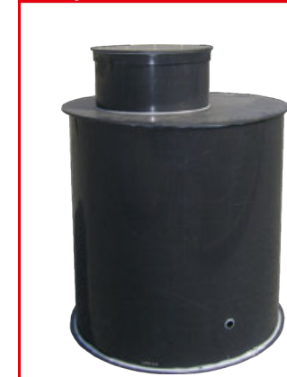
Šachta vodoměrná kruhová samonosná, bez potřeby dodatečného obetonování, k instalaci v zelených páslech nebo jiných nepojížděných plochách, s prostory pro potrubí a s žebříkem, výška komínku 300 mm
