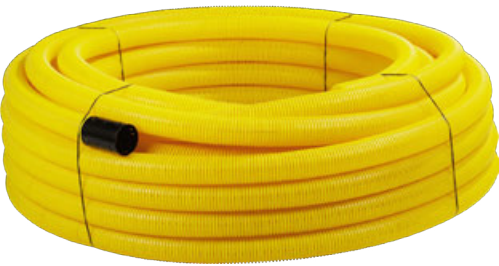
Potrubí meliorační Fränkische FF-drän celoperforované, perforace 29–51 cm 2 /m, vhodné ke strojní pokládce, materiál PVC-U
