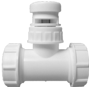
Ventil přívzdušňovací HL905N určený na podomítkovou instalaci do přiček, délkově upravitelná stavební ochranná zátka, vyjímatelný funkční díl s těsnící membránou a kryt jsou v balení, materiál PP/ABS, jmenovitá světlost DN 50/75, průtok 13l/s
