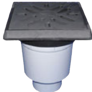
Vtok dvorní velkokapacitní HL606.1/1 svislý odtok s litinovým rámem 260×260 mm a litinovou mříží 226×226 mm, odkalovací koš, suchá klapka proti pronikání zápachu, DN 110
