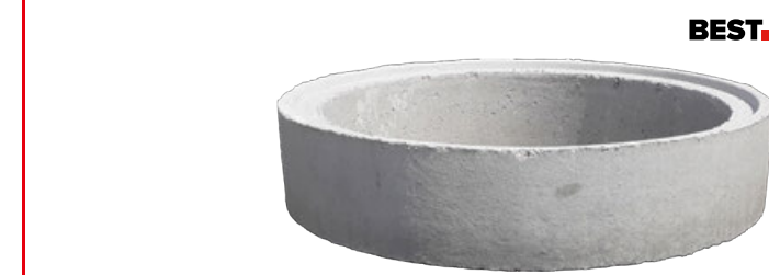
Skruž studniční BEST SR-F skruž z betonu třídy C35/45 s tloušťkou stěny 90 mm, vnitřní ø 800 mm
