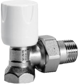
Ventil radiátorový rohový uzavírací a regulační prvek teplovodních systémů vytápění především s nuceným oběhem vody do pracovního tlaku 10 bar
