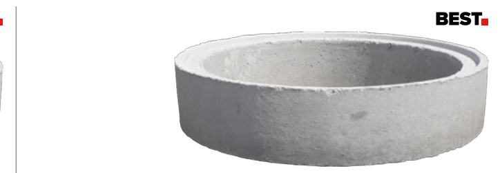
Skruž studniční BEST SR-F skruž z betonu třídy C35/45 s tloušťkou stěny 90 mm, vnitřní ø 1 000 mm
