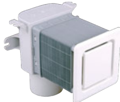
Ventil přívzdušňovací HL905N určený na podomítkovou instalaci do přiček, délkově upravitelná stavební ochranná zátka, vyjímatelný funkční díl s těsnící membránou a kryt jsou v balení, materiál PP/ABS, jmenovitá světlost DN 50/75, průtok 13l/s
