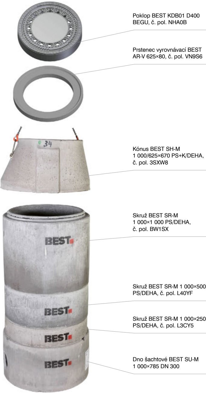
Příklad sestavy kanalizační šachty DN 1000 M
