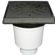
Vtok velkokapacitní HL606/1 svislý odtok DN 110, suchá zápachová uzávěra, s plastovým rámem, materiál PP, litina, mřížka litinová 226×226 mm
