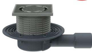
Vpust podlahová HL90Prblue ležatý odtok DN 40/50, zápachová uzavěra Primus blue kombinovaná (vodní a mechanická), pro skladyby souvrství podlahy menší než 100 mm, materiál polypropylen/nerezová ocel, mřížka nerezová 115×115 mm
