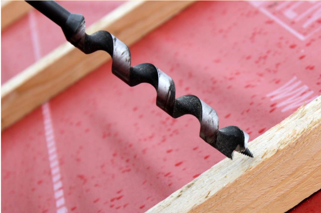
Obr 16. - Spirálový vrták pro zahloubení dosedací plochy pro hlavu vrutu
