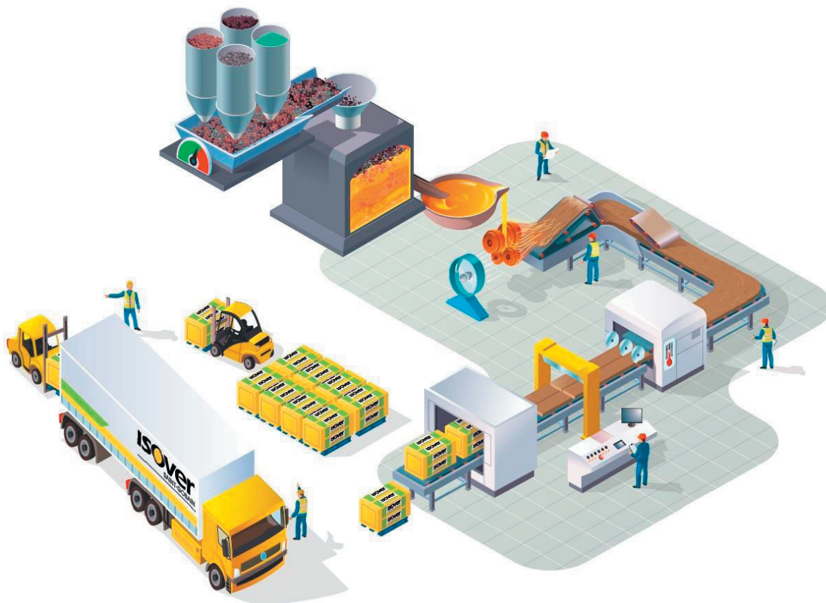
Obr. 3 – Schéma výroby minerální vlny
