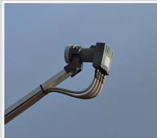
Zde se pro příjem připojí 4 koaxiální kabely.
