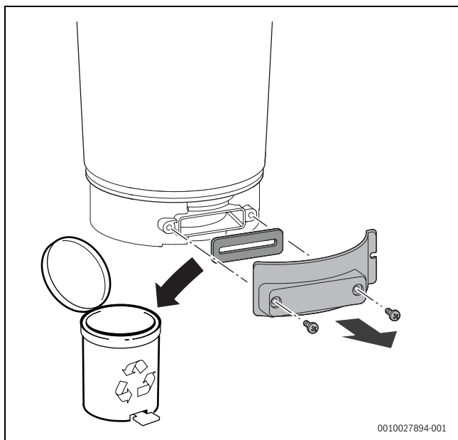
Obr. 175 Otevření revizního otvoru
