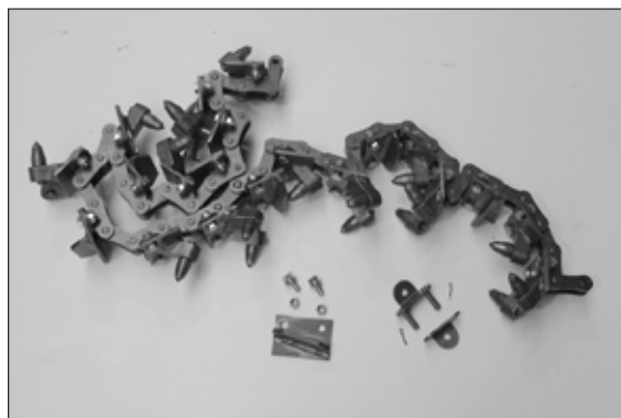
C Frézovací řetěz s přípojovacím článkem, 2 šrouby a matice, 2 rozdělené čepy
