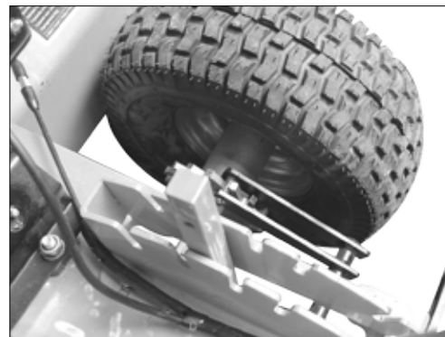
Blokované oběžné kolo s západka na Nastavení hloubky frézování od 1 - 3 (MIN. - MAX.).
