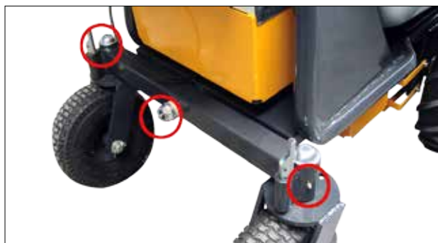
Otočte otočné body kyvné nápravy každých 80 provozních hodin.
