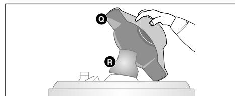
wyjąć deflektor wyciągnąć drucianą szczotką przewód spalinowy, zwracając uwagę aby nie uszkodzić powierzchni.
