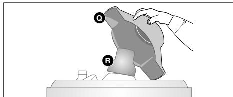
vytiahnite spomaľovač spalín a kovovým kartáčom ho očistite od spalín. Zvýšenú pozornosť venujte tomu, aby ste nepoškodili povrchovú úpravu.
