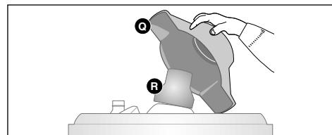
vyjměte odvzdušňovač kouře a vyčistěte kouř s kovovým kartáčem a dejte pozor, aby ste jeho nátěr nepoškodili.
