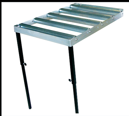
VÁLEČKOVÝ BOČNÍ STŮL (volitelné) Sestaven z 5-ti pozinkovanými válečky osazenými kuličkovými ložisky. Rozměry: 800 x 600 mm.
