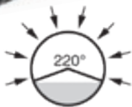
LP částečně perforované drenážní trubky
