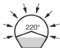
LP částečně perforované drenážní trubky
