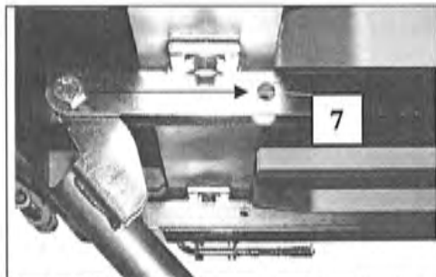
Obr. 51 Vymezení teleskopické podpěry
