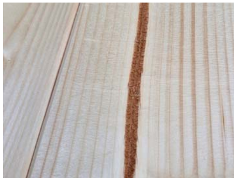
07 | smrková palubka kvality B obsahující dřeň šířky větší než 5 mm
