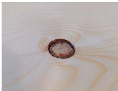
08 | detail smrkové palubky kvality A se sukem s kůrou do velikosti 10 % šířky + 15 mm
