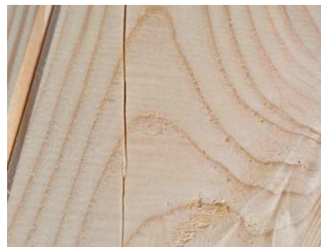
06 | smrková palubka kvality B s vlasovou trhlinou šířky do 1 mm a délky do 300 mm
