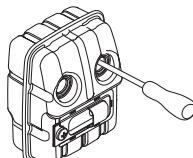
Jeśli tłumik w Twojej maszynie jest wyposażony w siatkę przeciwiskrową, należy ją regularnie czyścić. Zanieczyszczona siatka powoduje przegrzewanie się silnika, co może być przyczyną poważnych uszkodzeń.
