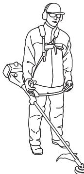
• Trzymaj wszystkie części ciała z dala od obracającego się osprzętu tnącego. Osprzęt tnący trzymaj na wysokości poniżej pasa.
