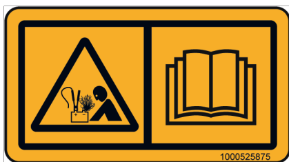
Obr. 18: Nebezpečí výbuchu baterie
