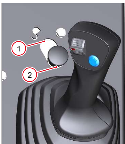
Obr. 78: Blokovací páka pracovní režim/silniční režim
