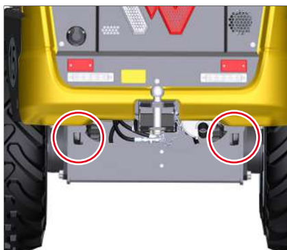
Obr. 117: Vázací oka na hnací jednotce
