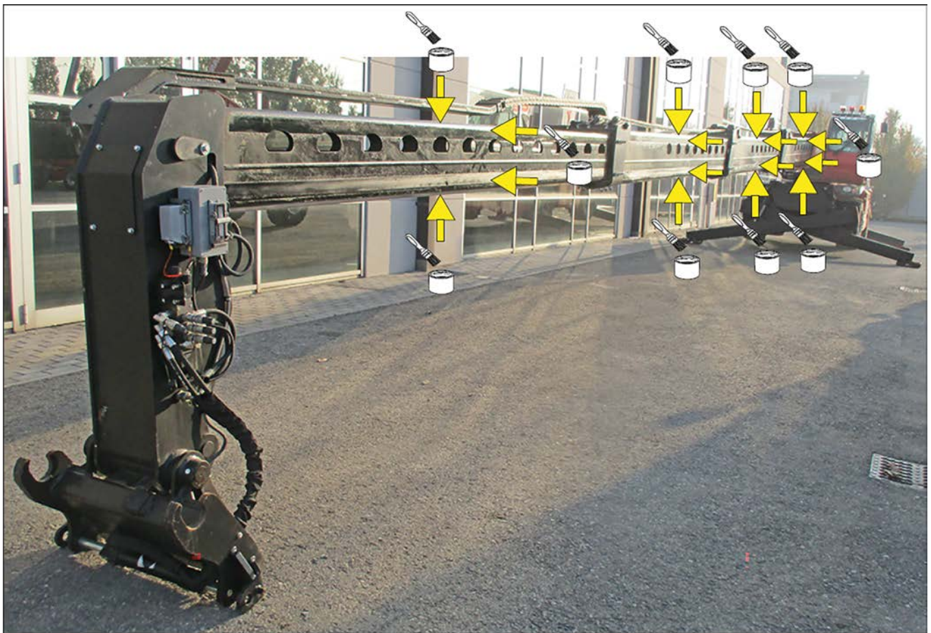
Obrázek 156: Čištění a mazání otěrových patek teleskopického ramene
