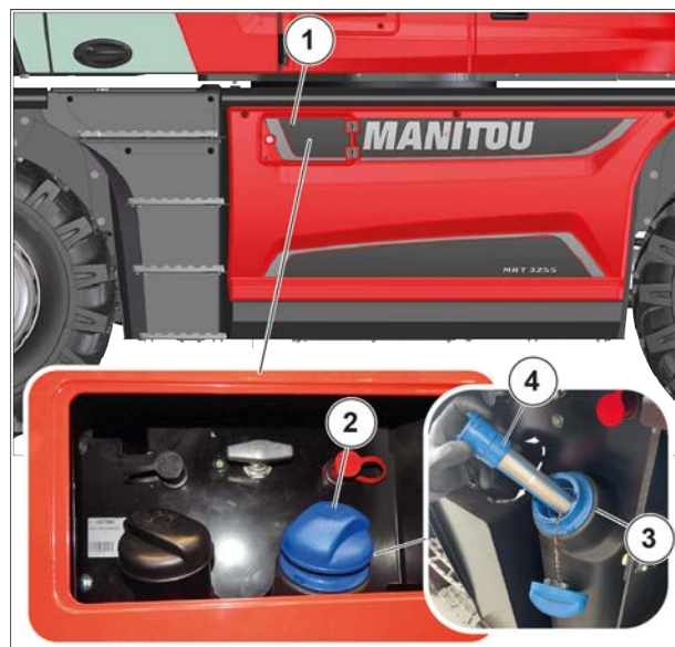
Obrázek 226: Kontrola a čištění filtru plnicího hrdla nádrže kapaliny DEF
