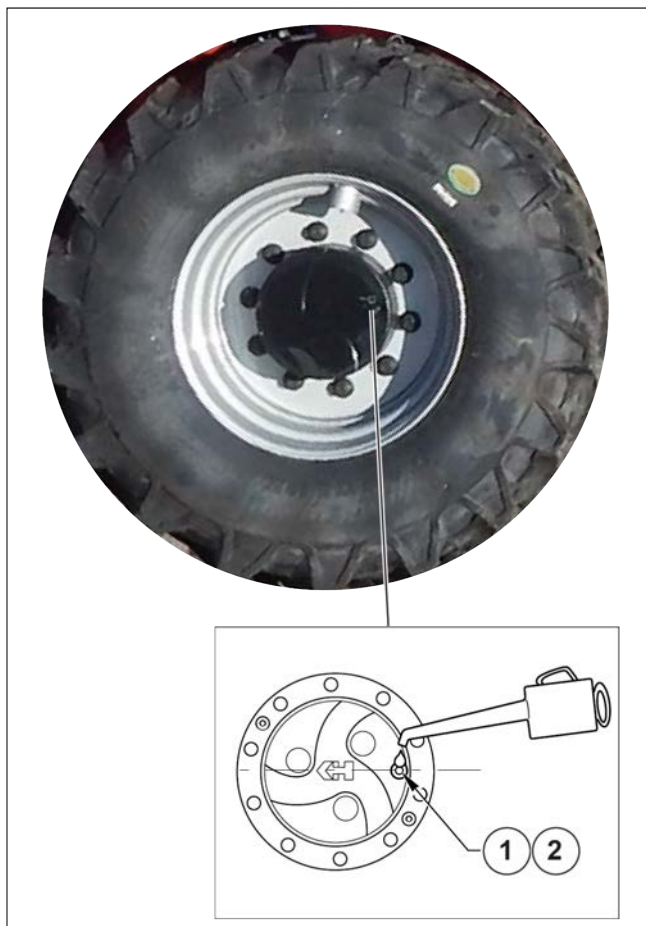
Obrázek 162: Kontrola hladiny oleje reduktoru předního a zadního kola
