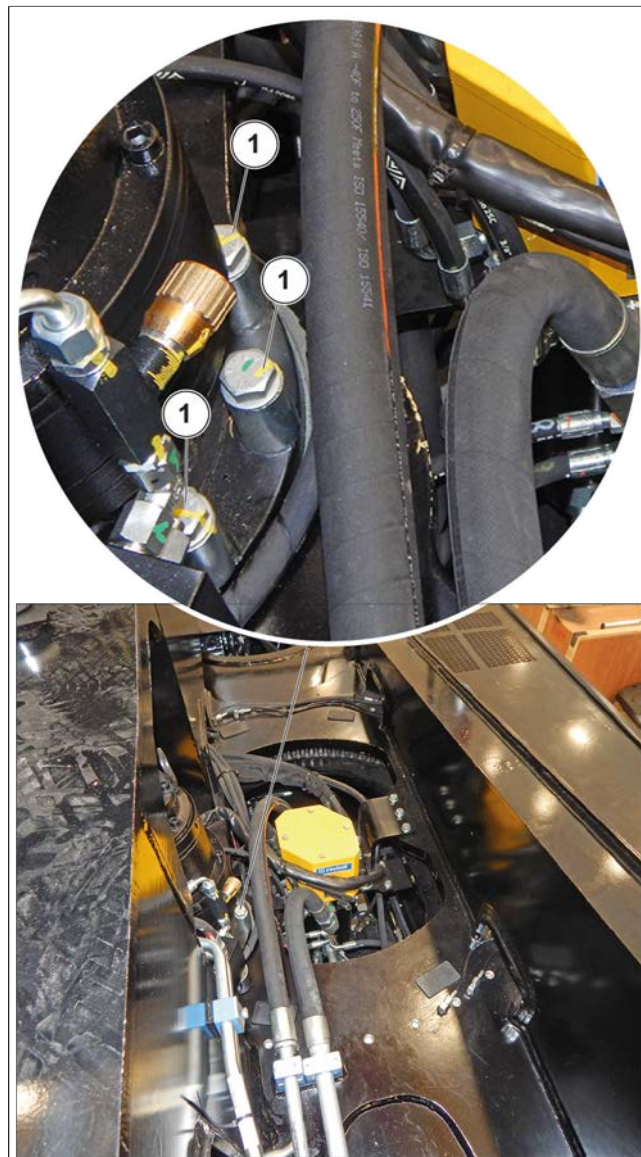
Obrázek 166: Kontrola dotažení upevnovacího šroubu reduktoru otáčení
