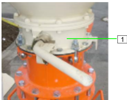
Obrázek 32: Uzavření klapky výstupu sila
