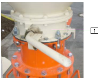
Obrázek 22: Otevření klapky výstupu síla
