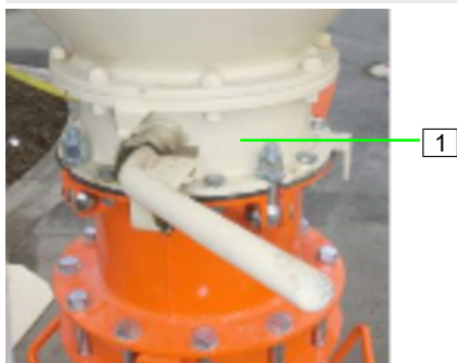
Obrázek 39: Uzavření klapky výstupu síla
