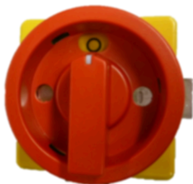
Obrázek 28: Hlavní reverzní spínač do polohy „0“.
