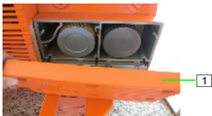
Obrázek 49: Uvolnění víka filtru
