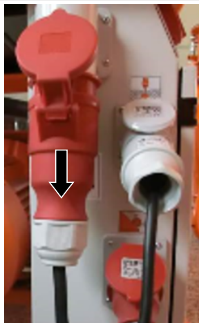
Obrázek 29: Přerušení přívodu proudu
