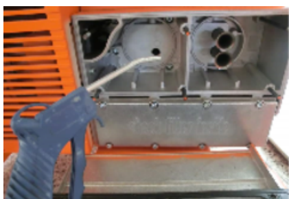
Obrázek 52: Čištění tělesa filtru
