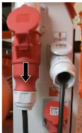
Obrázek 44: Přerušení přívodu proudu
