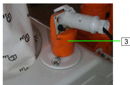
Obrázek 16: Připojení řídicího kabelu
