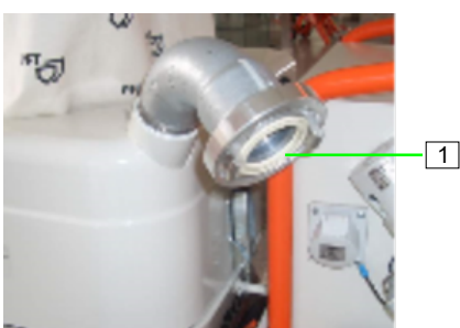
Obrázek 19: Připojení přívodní hadice
