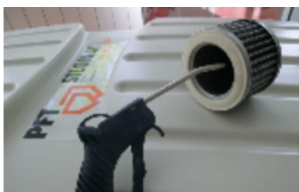
Obrázek 51: Vyčištění filtračních patron
