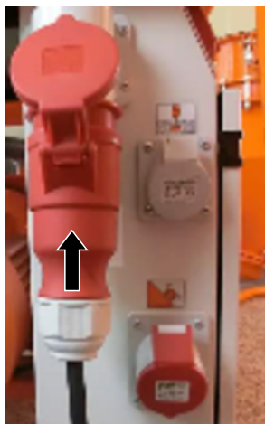
Obrázek 14: Připojení napájecího zdroje
