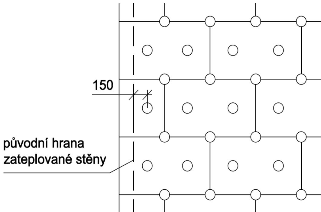
Obrázek 17 - Kotvení tepelné izolace v nároží fasády
