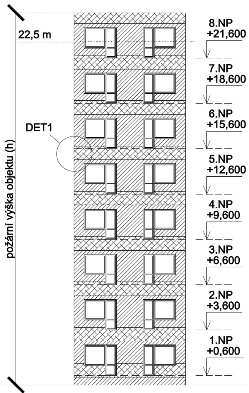
Obrázek 2 – Zateplení objektů s požární výškou  $12,0 < h \leq 22,5$  m
