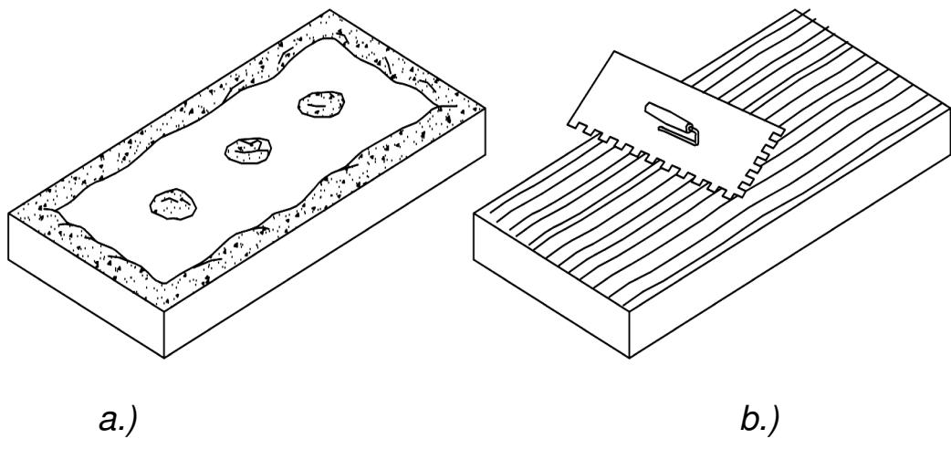
Obrázek 11 - Nanášení lepicí hmoty na desku tepelné izolace
