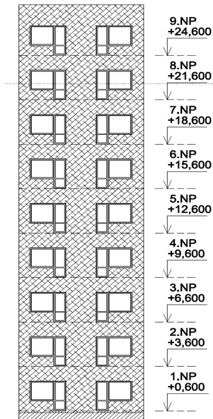
Pro ucelené stavební objekty je nutné použít vnější tepelněizolační kompozitní systém (na celou výšku objektu) pouze s třídou reakce na oheň A1 nebo A2. Výjmkou je oblast soklu. Obrázek 6 – *Zateplení objektů s požární výškou  $h > 22,5$  m dle požadavků ČSN 73 0810*
