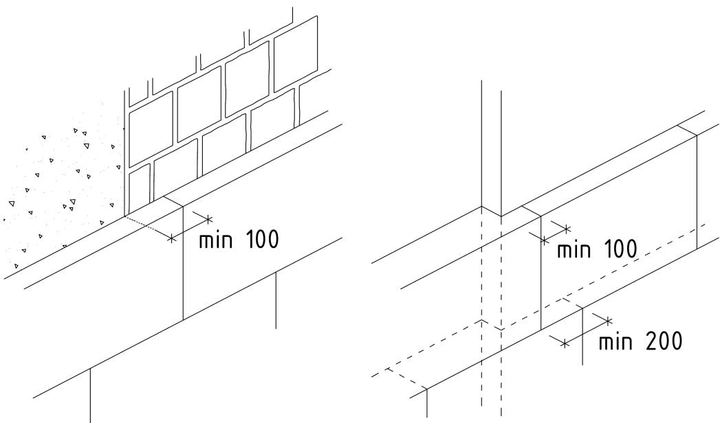
Obrázek 15 - Provedení tepelné izolace v místě nehomogenity podkladu. Vlevo styk dvou různých materiálů, vpravo změna tloušťky tepelné izolace.
