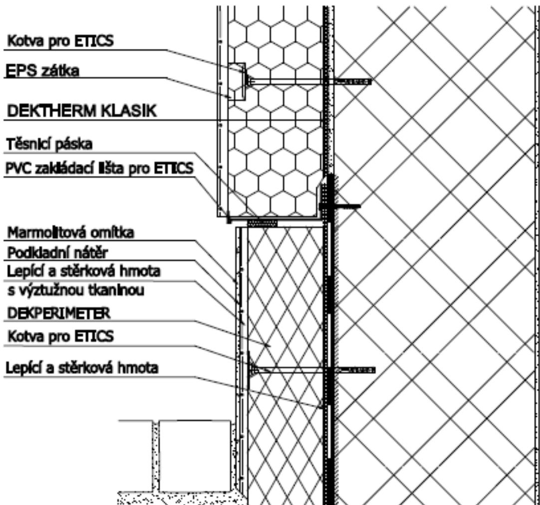
Obrázek 20 - Detail soklu s omítkou ukončenou u terénu, přiznaný sokl
