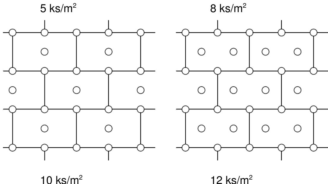
*Rozmístění hmoždinek pro kotvení desek z tužených minerálních vláken s kolmou orientací vláken (lamely 1000 x 200 mm, 1000 x 333 mm)*
