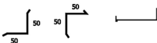
Obrázek 25 - Napojení fasádního systému na plochou střechu s povlakovou hydroizolací z mPVC fólie
