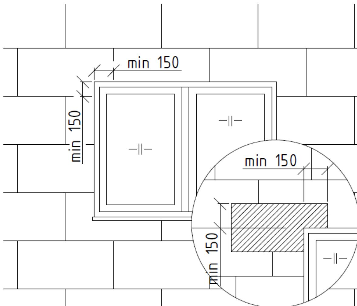
Obrázek 13 - Správné provedení izolačních desek v místě okenních otvorů (platí pro nadpraží i parapet)
