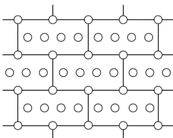
*Rozmístění hmoždinek pro kotvení desek z tužených minerálních vláken s podélnou orientací vláken (1000 x 600 mm)*
