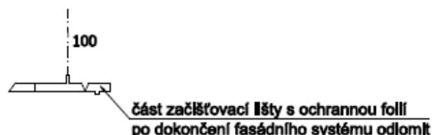
Obrázek 23 - Nadpraží okna se začistujovací lištou
