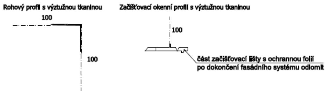
Obrázek 22 – Ostění okna se začlešťovací lištou
