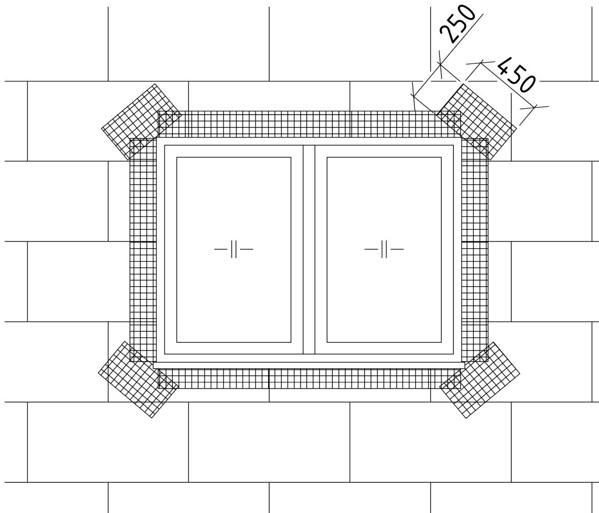
Obrázek 18 - zesílení výztužné vrstvy v okolí okenního otvoru
