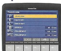
Nastavení průtoku hydraulického oleje pro sbíječku nebo dříci se provádí pod položkou „Attachment“ v nabídce pro uživatele. (Podrobnosti jsou uvedeny v Příručce pro provoz a údržbu) (\*1)
