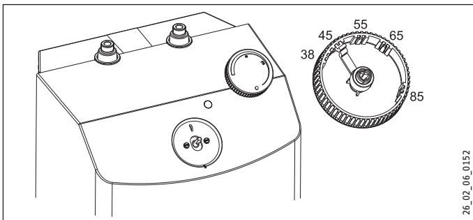
Dźwignia na spodzie pokrętła regulacji temperatury pozwala na ograniczenie zakresu nastaw pokrętła regulacji temperatury, aby nie przekraczał on temperatury maksymalnej.
