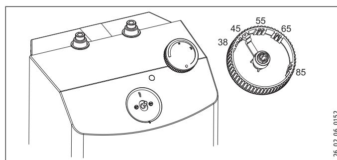
Páčkou na spodní straně knoflíku regulátoru teploty můžete rozsah nastavení knoflíku regulátoru teploty změnit omezením maximální teploty.
