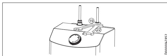
Accordez les codes couleur des raccords de la robinetterie à ceux de l'appareil :
