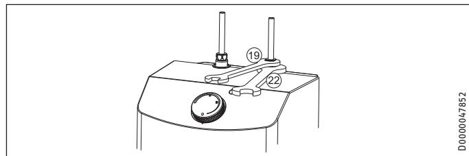
Přiřaďte dle barevného označení přípojky vody na armatuře a na přístroji.
