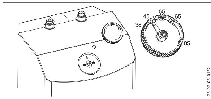
La température limite supérieure de la plage de réglage du bouton de réglage de température peut être ajustée à l'aide du levier situé sur la face inférieure du bouton de réglage de température.
