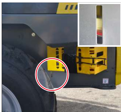
Obr. 234: Nahlížeč otvor odlučovače vody
