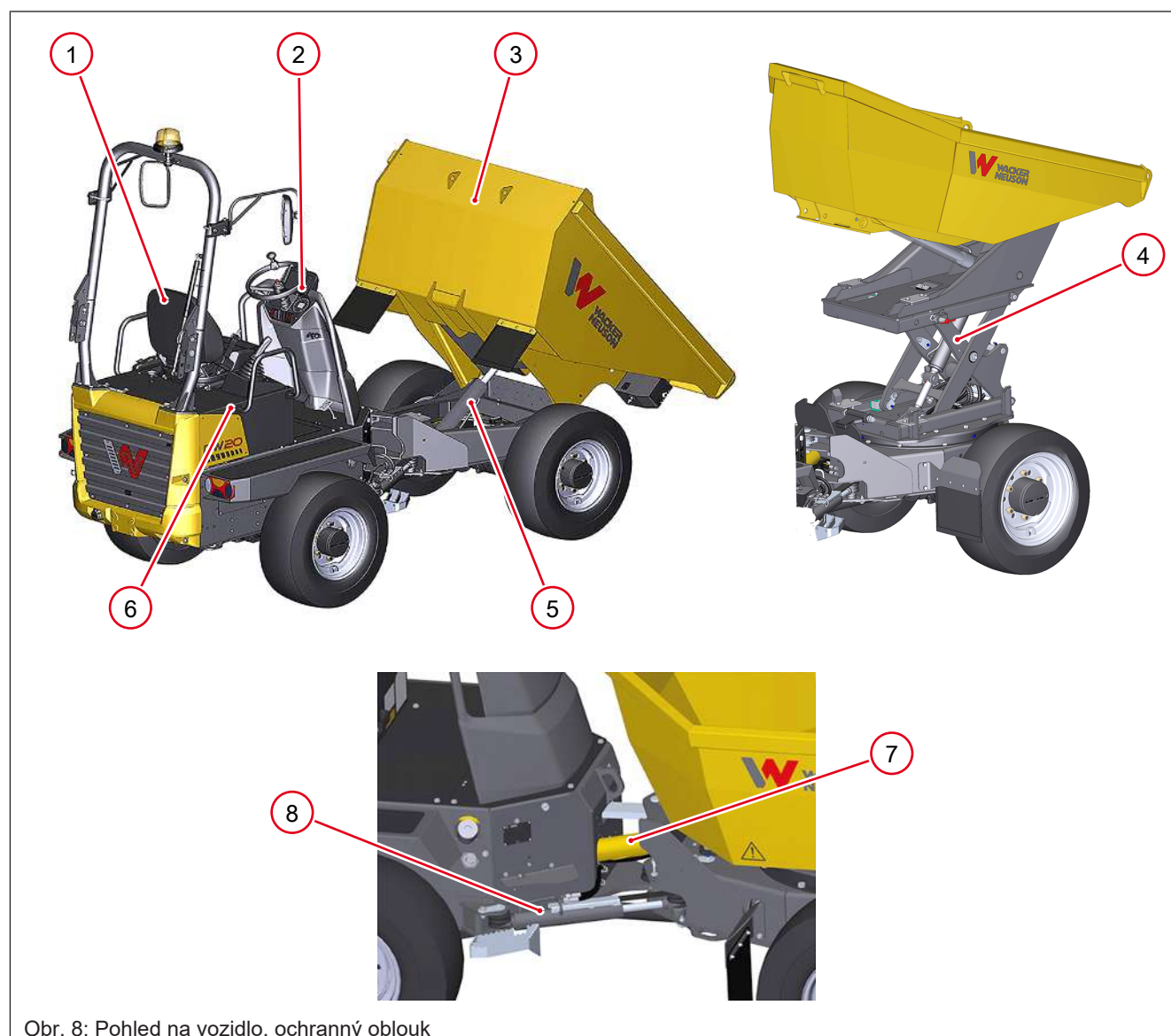
Obr. 8: Pohled na vozidlo, ochranný oblouk
